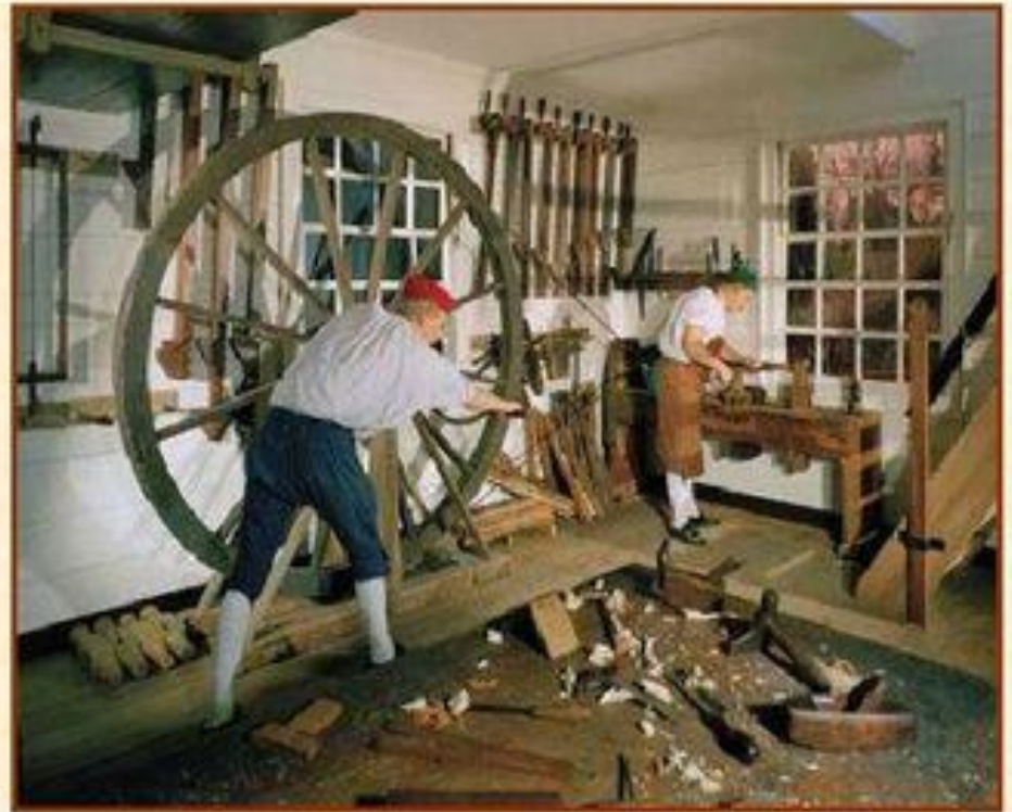
Токарный станок с канатным ручным приводом от маховика
