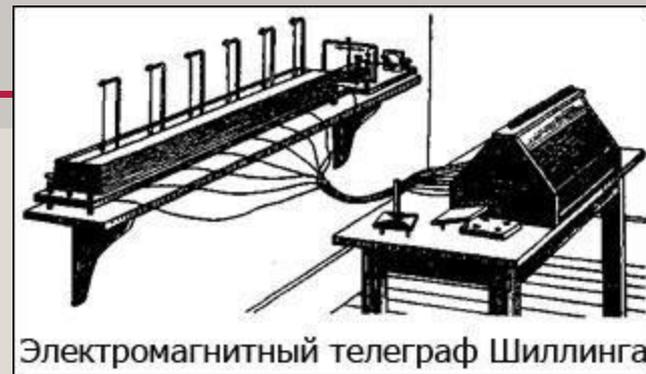
Конструкция плода его стараний была такая: пять магнитных стрелок, подвешенные на шелковых нитях, двигались внутри «мультипликаторов».
