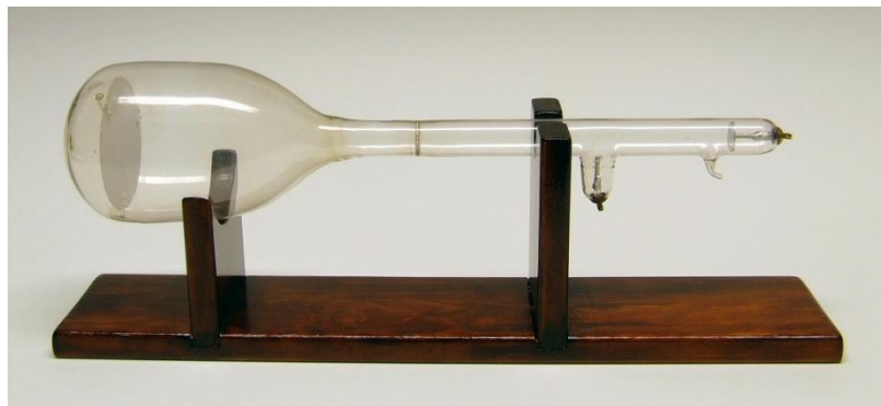
Трубка Брауна(прототип кинескопа) – 1897 г.
