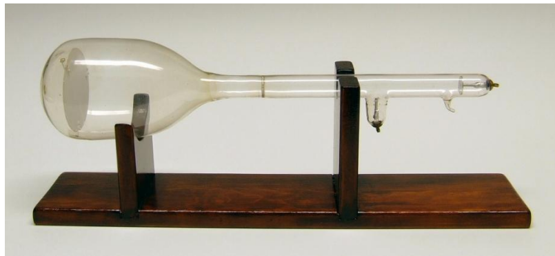
Трубка Брауна(прототип кинескопа) – 1897 г.
