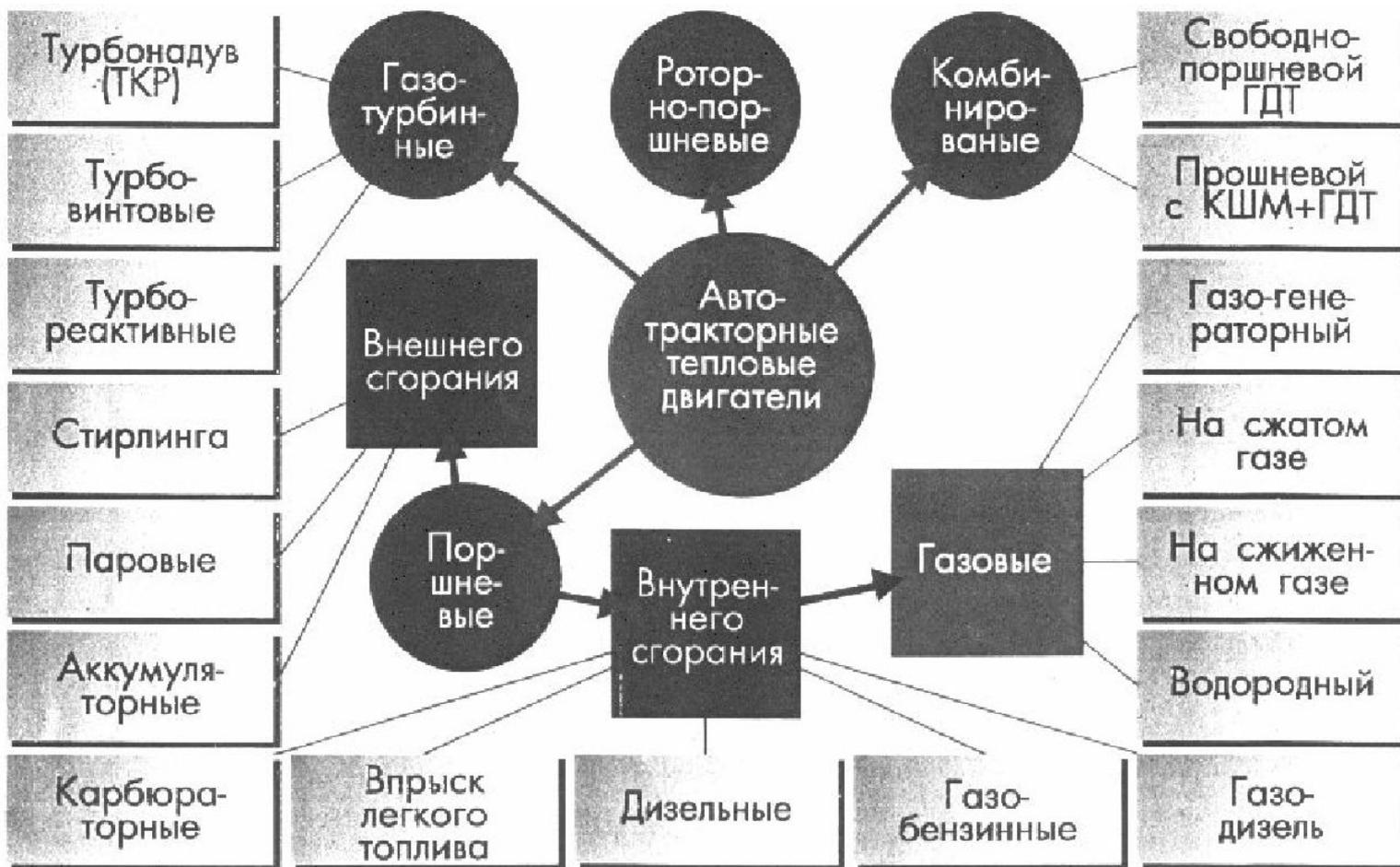
**Поршневым двигателем внутреннего сгорания (ДВС)** называют такую тепловую машину, в которой превращение химической энергии топлива в тепловую, а затем в механическую энергию, происходит внутри рабочего цилиндра.
