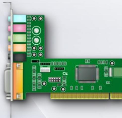
**позволяет работать со звуком на компьютере. В настоящее время звуковые карты бывают как встроенными в материнскую плату, так и отдельными платами расширения или как внешними устройствами.**
