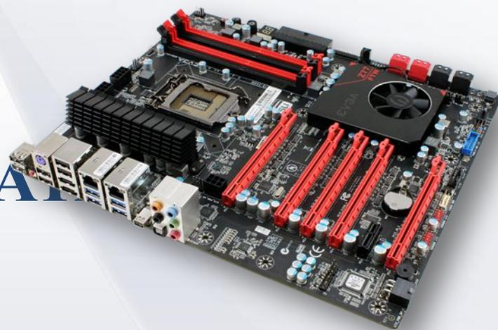
**печатная плата, на которой монтируется чипсет и прочие компоненты компьютерной системы.**
