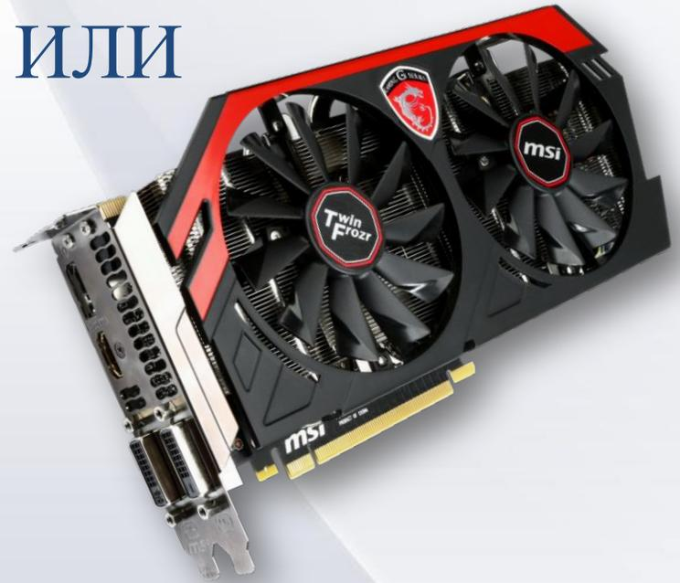
устройство, преобразующее изображение, находящееся в памяти компьютера, в видеосигнал для монитора. Обычно видеокарта является платой расширения и вставляется в специальный разъём для видеокарт на материнской плате, но бывает и встроенной, иначе говоря, интегрированной.
