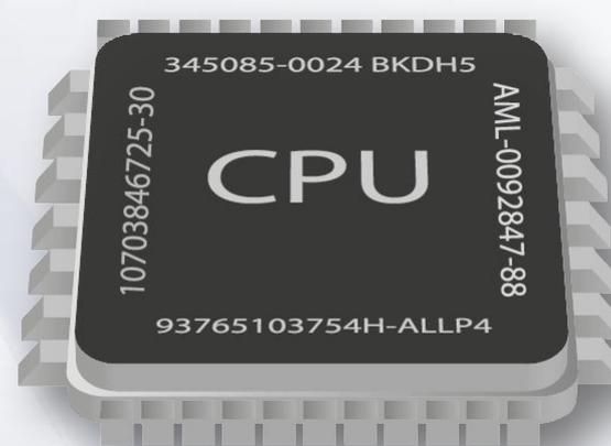
это «мозг» любого компьютера. Процессор производит все вычисления (арифметические и логические операции), взаимодействует с памятью и осуществляет управление всеми компонентами ПК. Таким образом, процессор включает в себя следующие части:
