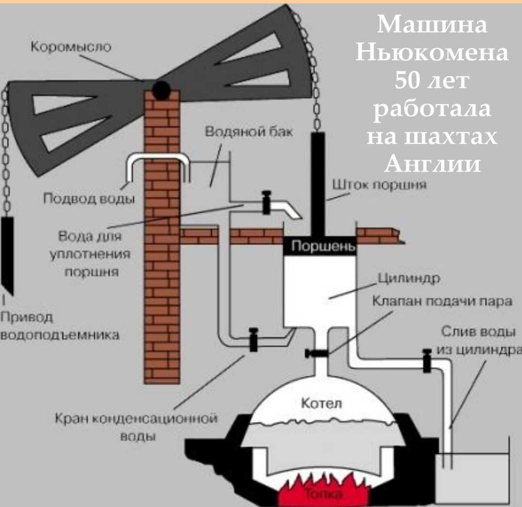
Пароатмосферная машина Томаса Ньюкомена (1705 г.)
