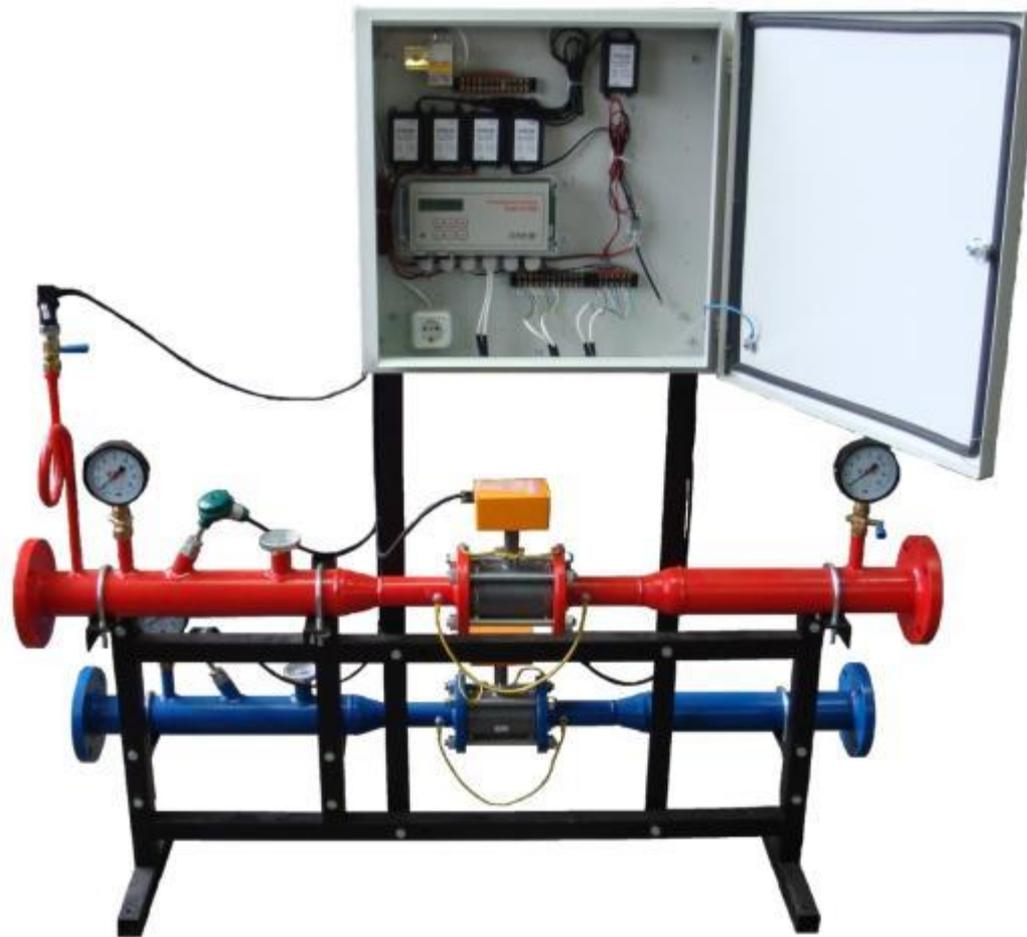
**Измерительная установка** - это совокупность функционально объединенных средств измерений (мер, измерительных приборов, измерительных преобразователей) и вспомогательных устройств, предназначенных для выработки сигналов измерительной информации в форме, удобной для непосредственного восприятия наблюдателя и расположенных в одном месте
