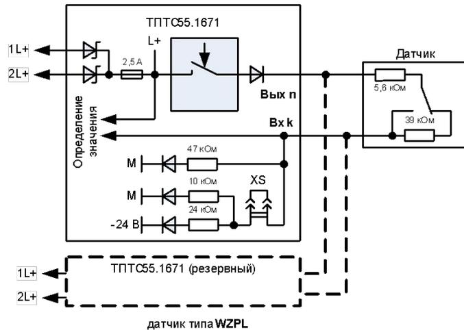
**Схемы подключения датчиков с переключающим контактом с использованием двухпроводного монтажа**
