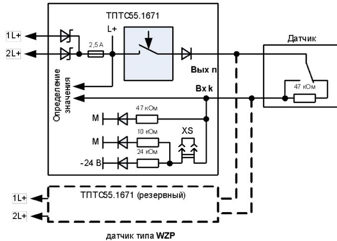
**WZP** - схема с диагностикой цепей подключения; диагностируются: обрыв, замыкание на потенциал 0 В;
