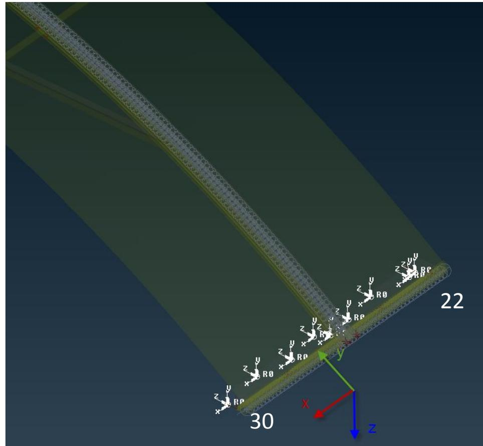
Нижний профиль опирается на край основания, винты работают на отрыв.
