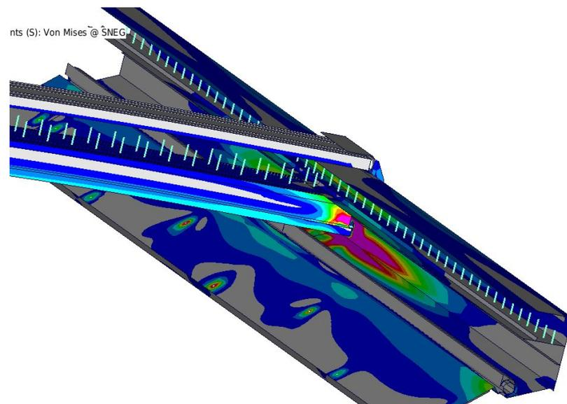
Наиболее нагруженным местом является соединение нижней дуги с боковым профилем. Область с пластической деформацией.
