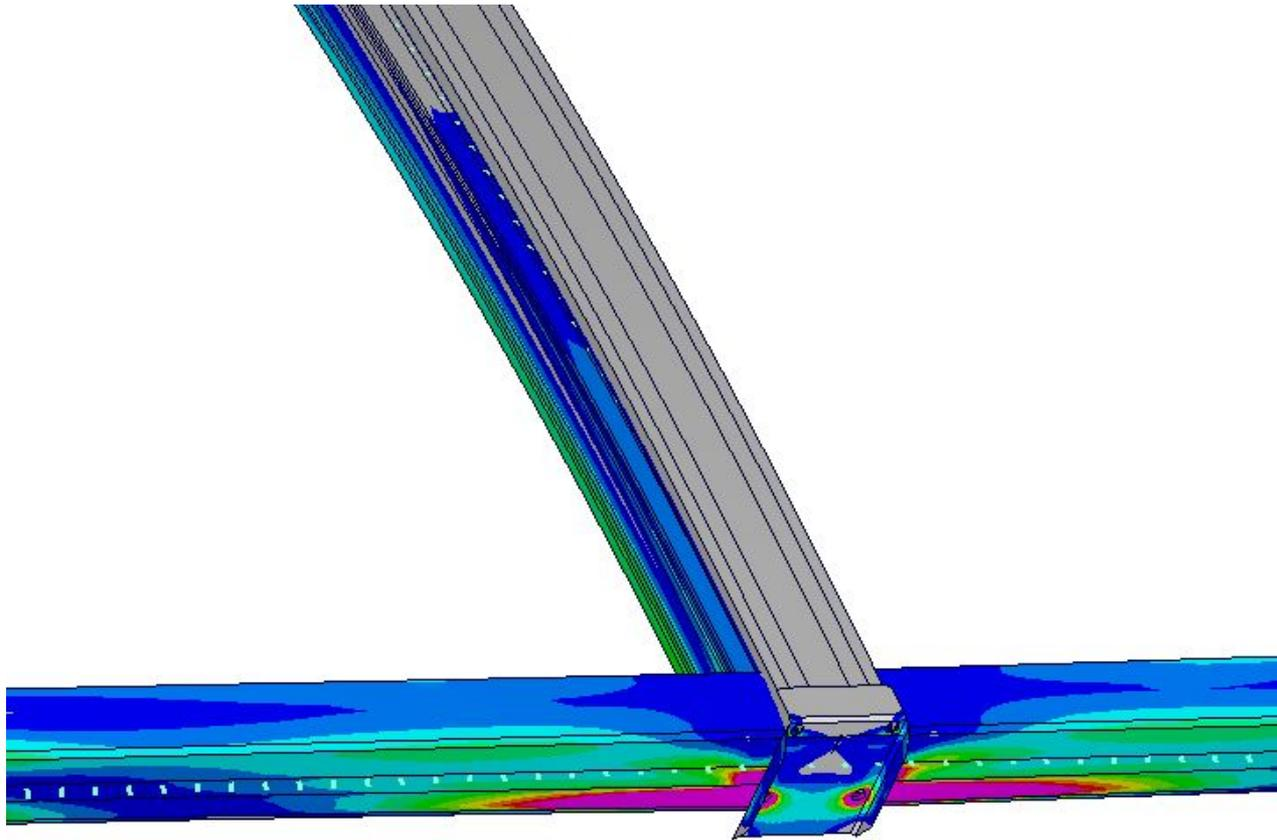
Место пластической деформации. Нужно оценивать деформации по модели с пластичностью.
