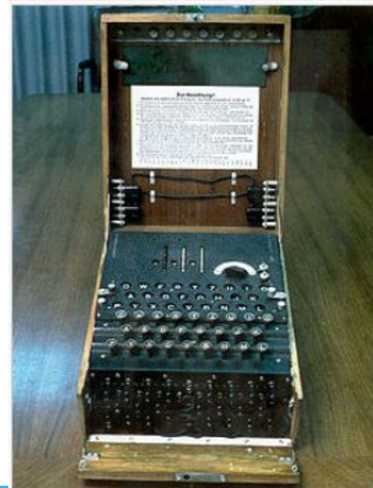
Роторная шифровальная машина Энигма, разные модификации которой использовались германскими войсками с конца 1920-х годов до конца Второй мировой войны [1]
