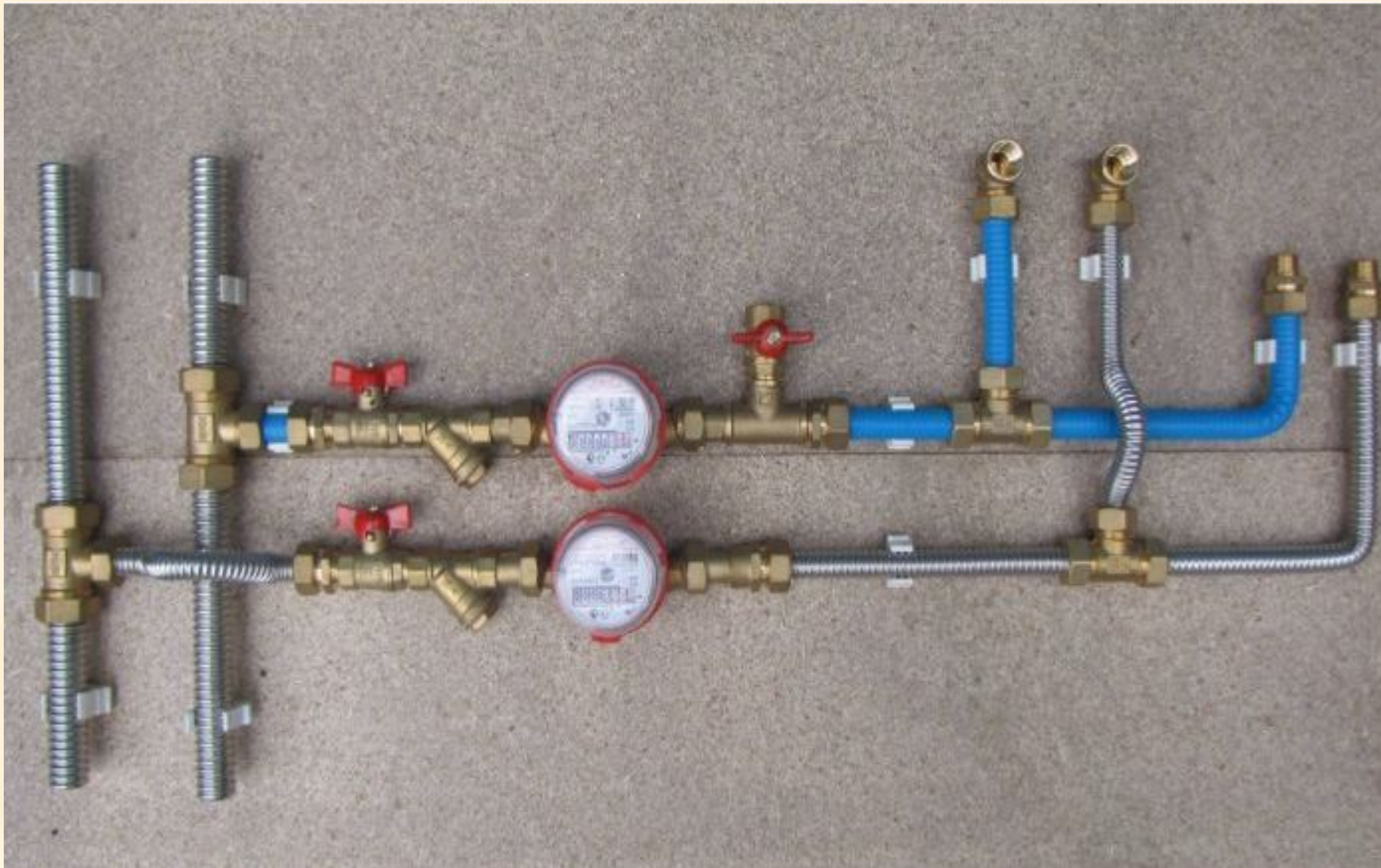
Рис. 1. Примеры соединения трубопроводов фитингами
