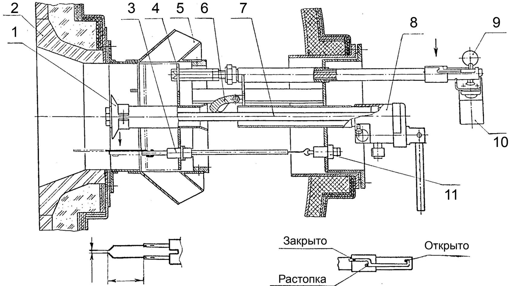
1. Диффузор (конический стабилизатор); 2. Фурма; 3. Запальное устройство; 4. Регистр ВНУ; 5. Завихритель ВНУ; 6. Захлопка; 7. Топливная форсунка; 8. Втулка форсунки; 9. Ручной привод регистра; 10. Сигнализатор положения регистра; 11. Разъем.
