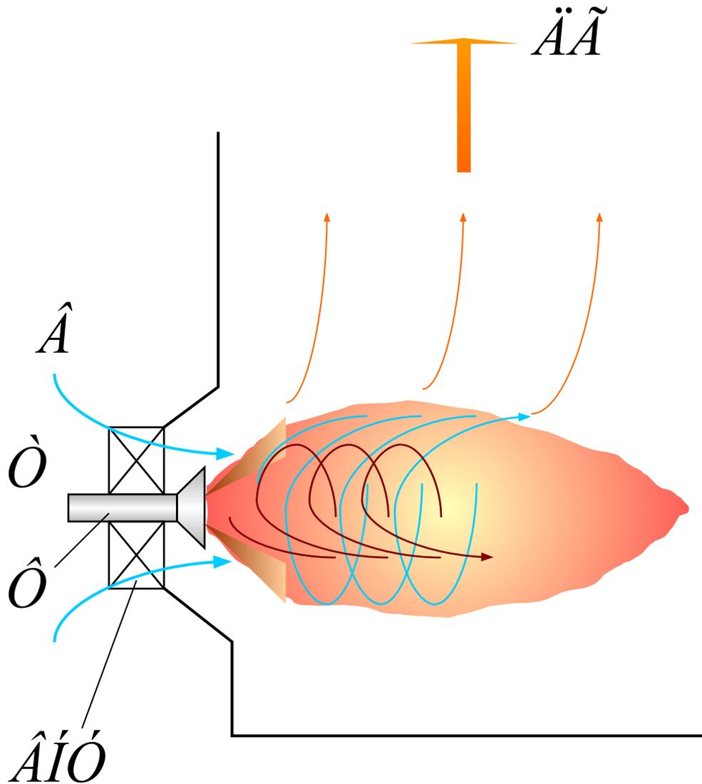
1. непрерывное движение топливных частиц вместе с газовой воздушным потоком, в котором они сгорают во взвешенном состоянии;
