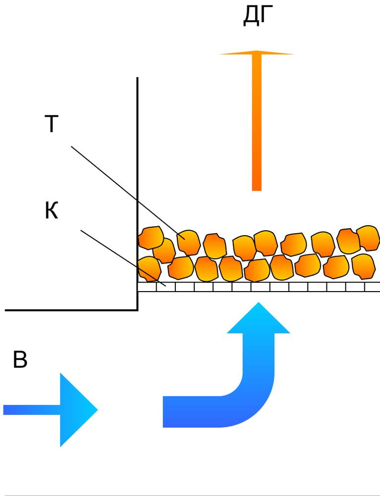
1. значительный запас топлива в слое, соизмеримый с часовым расходом топлива;
