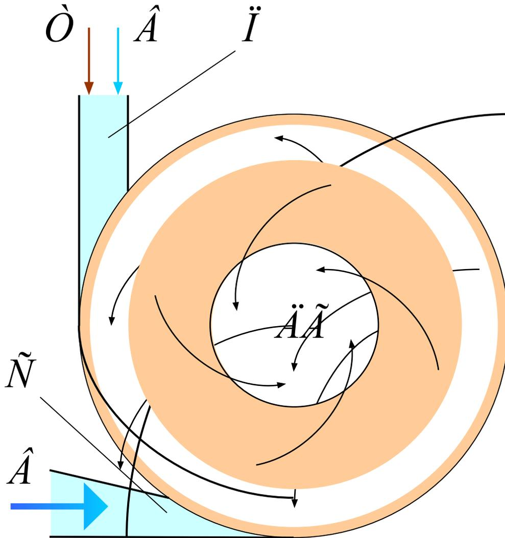
1. образование в камере устойчивого циклона (вихря);
