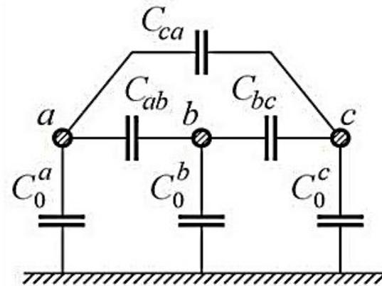
В практических расчётах рабочую ёмкость трёхфазной ВЛ с одним проводом в фазе на единицу длины (Ф/км) определяют по формуле
