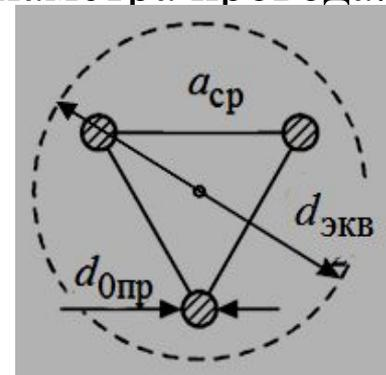
$$x_0 = 0,144 \lg \left( \frac{2D_{\text{СР}}}{d_{\text{ЭКВ}}} \right) + \frac{0,0157}{n_\phi} \quad b_0 = \frac{7,58 \cdot 10^{-6}}{\lg \left( \frac{2D_{\text{СР}}}{d_{\text{ЭКВ}}} \right)} \quad r_0 = \frac{r_{\text{ФР}}}{n_\phi}$$
