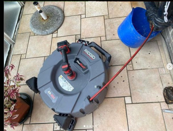
Прочистка ливневки/ прочистка стояков
