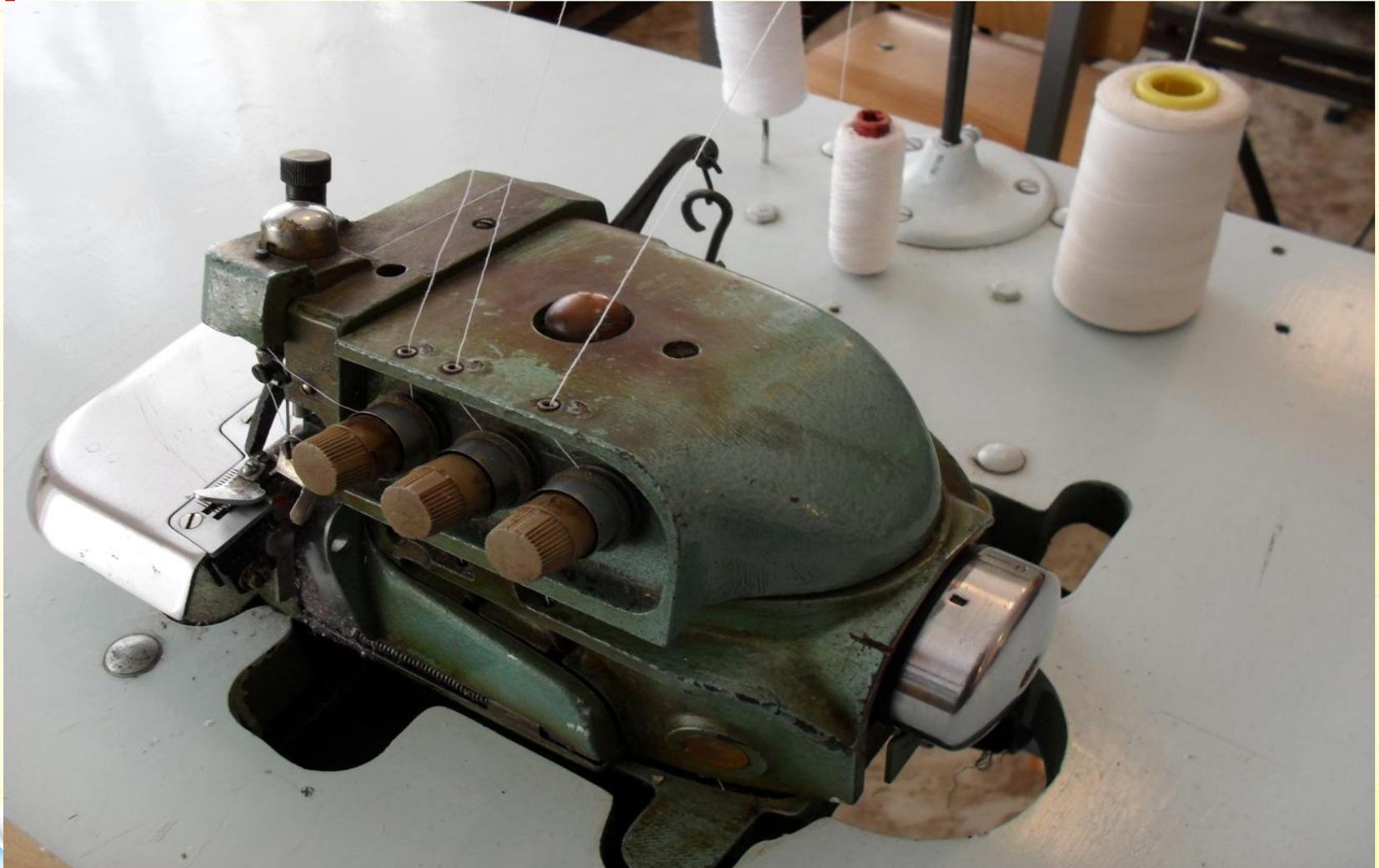
**Обметать срез низа изделия на специальной краеобметочной машине 51 класса.**
