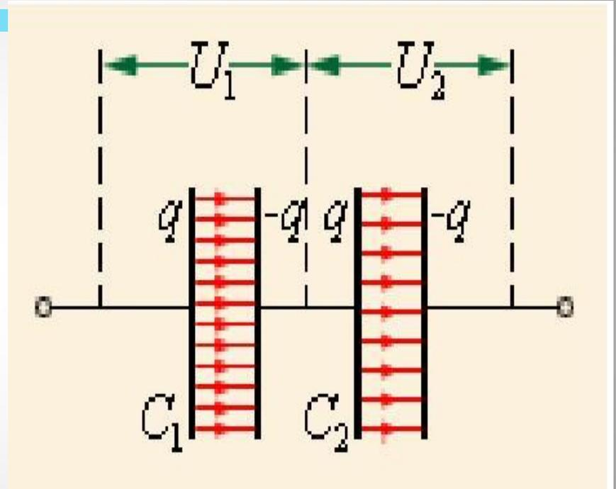
ЗАДАЧА № 3. батарея из двух конденсаторов 4 и 6 мкФ, соединенных последовательно, заряжена до напряжения 220 В. Определить емкость и заряд батареи конденсаторов.
