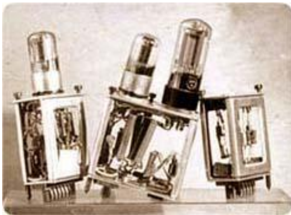
Ламповый элемент СЭСМ (Специализированной Электронной Счетной Машины)
