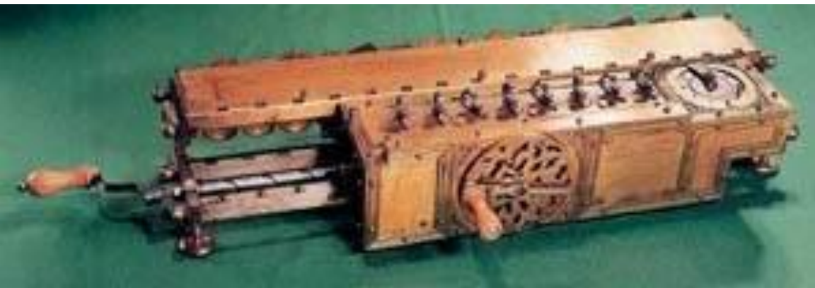
Механический арифмометр Лейбница (1673г.)
