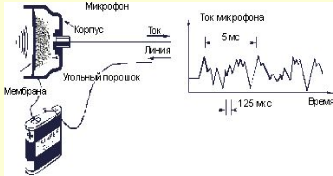
Рис. 2. Схема преобразования речи в электрический ток
