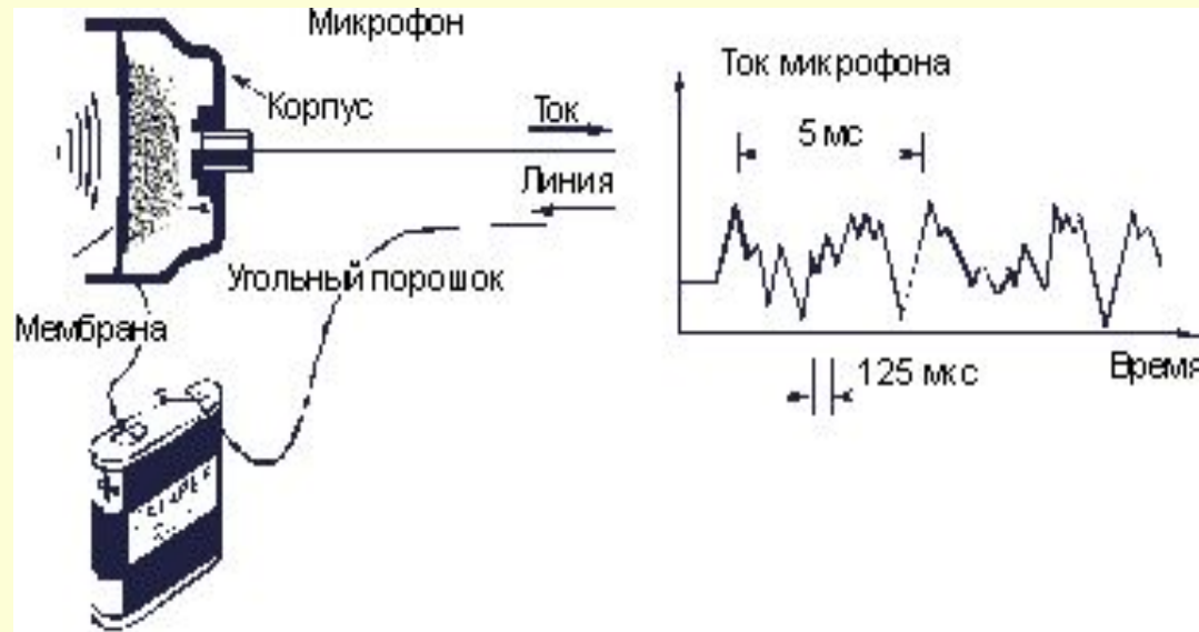
Рис. 2. Схема преобразования речи в электрический ток
