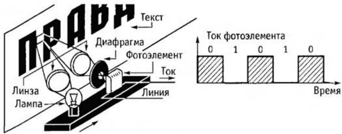
Рис 1. Преобразование изображения в электрический сигнал в факсимильном аппарате
