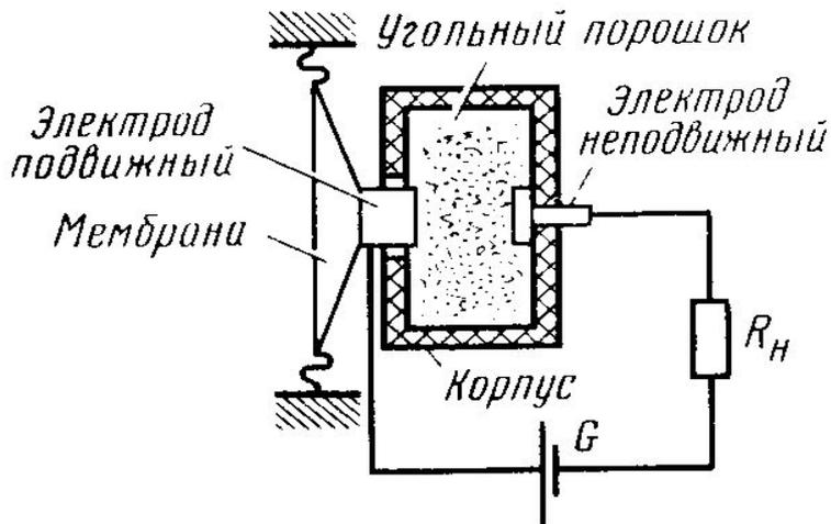
Рис. 1. Схема микрофона телефонного аппарата
