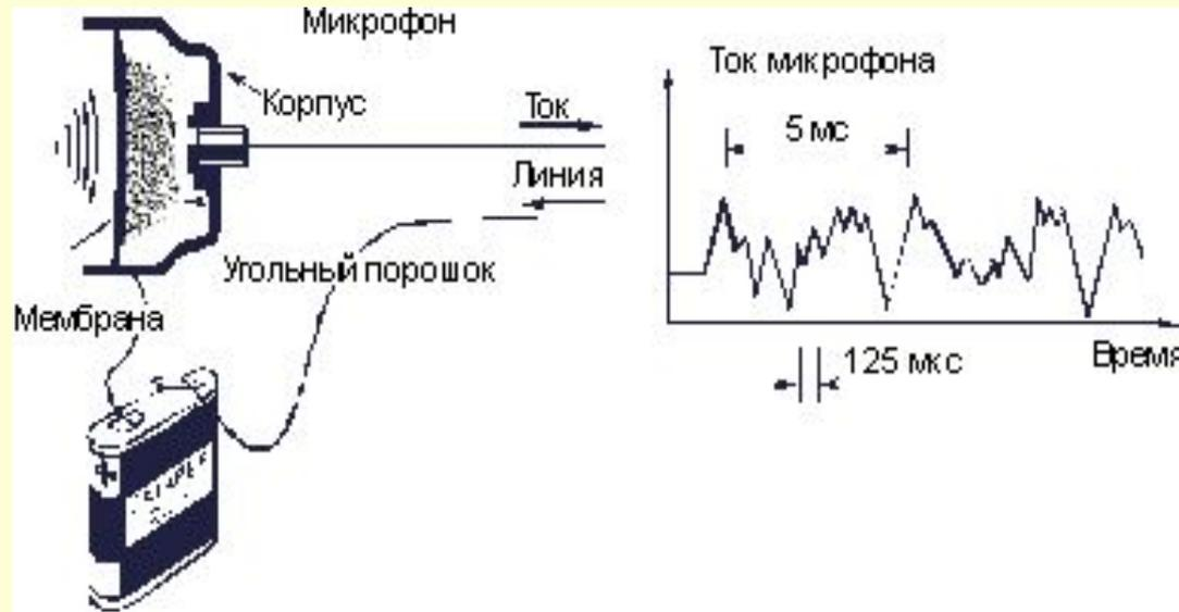
Рис. 2. Схема преобразования речи в электрический ток
