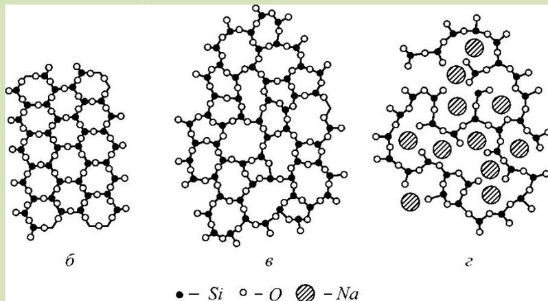
**Схематическое изображение на плоскости сочленения тетраэдров в структуре кристаллического (б) и стеклообразного кварца (в), а также силикатного стекла (г)**
