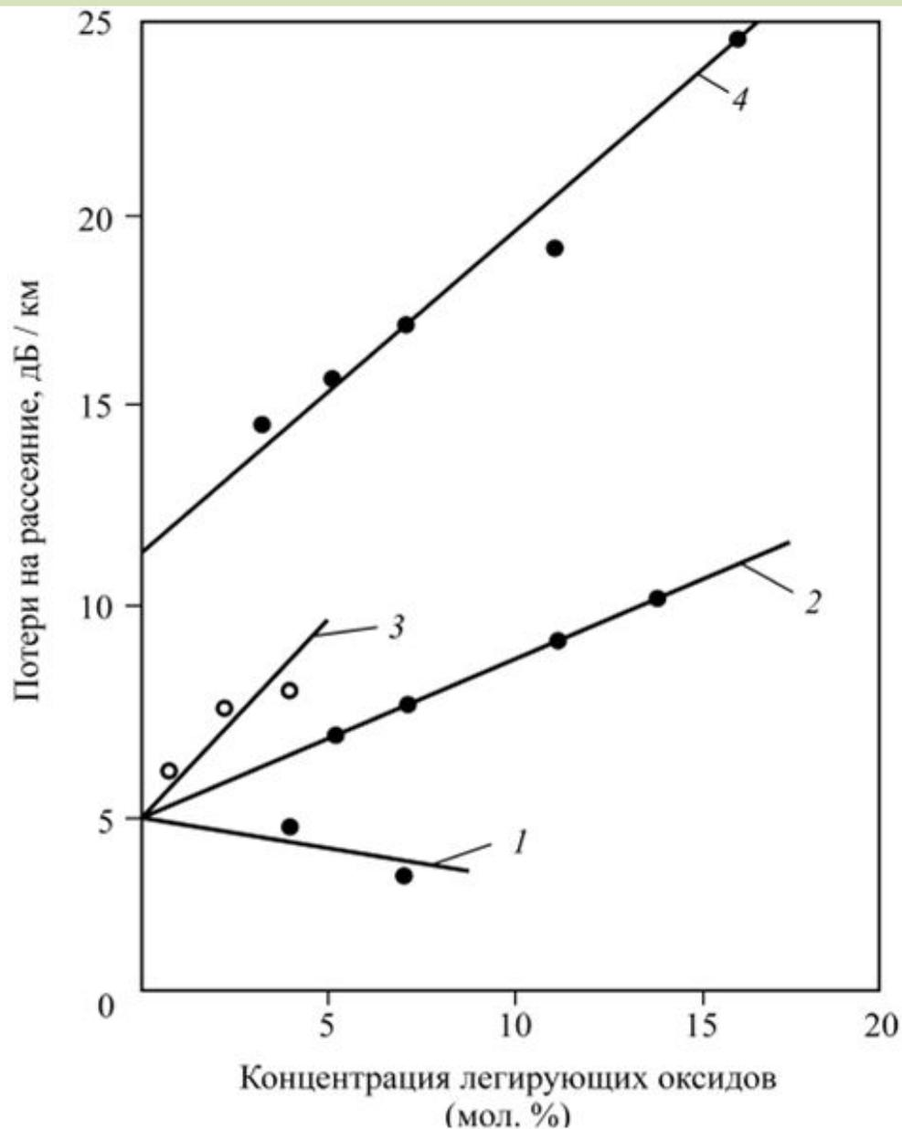
Зависимости потерь на рассеяние от концентрации легирующих примесей: 1 -  $P_2O_5$ ; 2 -  $GeO_2$ ; 3 -  $B_2O_3$  (для  $\lambda = 0,83$  мкм); 4 -  $GeO_2$  (для  $\lambda = 0,51$  мкм)
