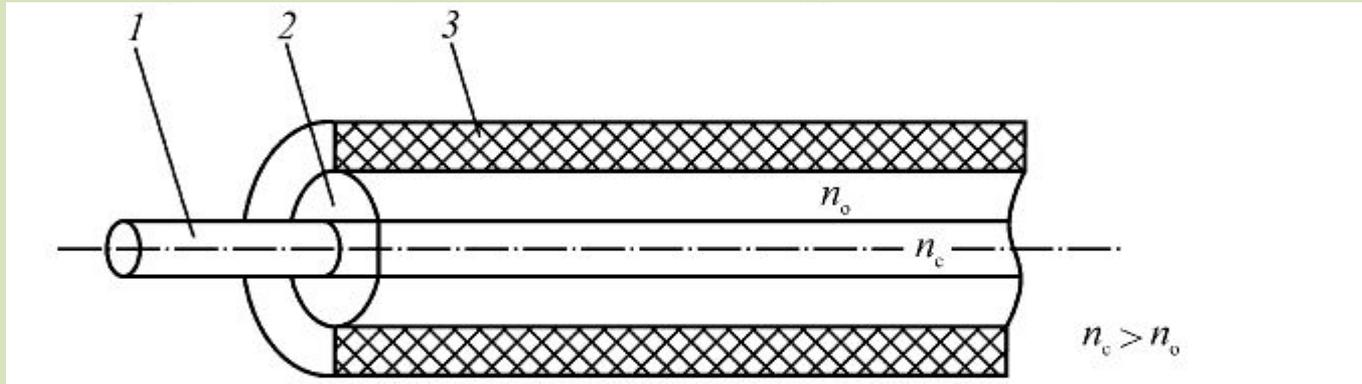
Структура оптического волокна: 1 – сердцевина; 2 – светоотражающая оболочка; 3 – защитно-упрочняющее покрытие
