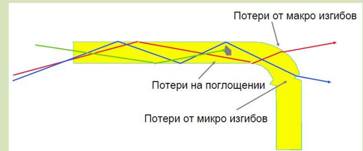
Распространение света в сердцевине и влияние на него изгибных, микроизгибных, поглощающих дефектов
