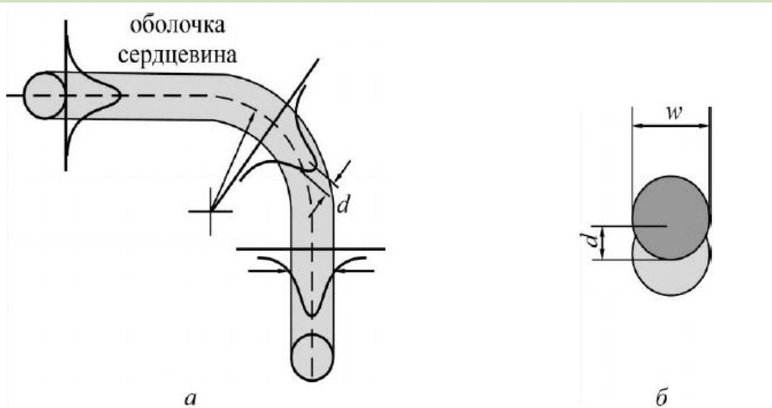
Схема, поясняющая причину возникновения потерь при соединении прямого и изогнутого волокна:
