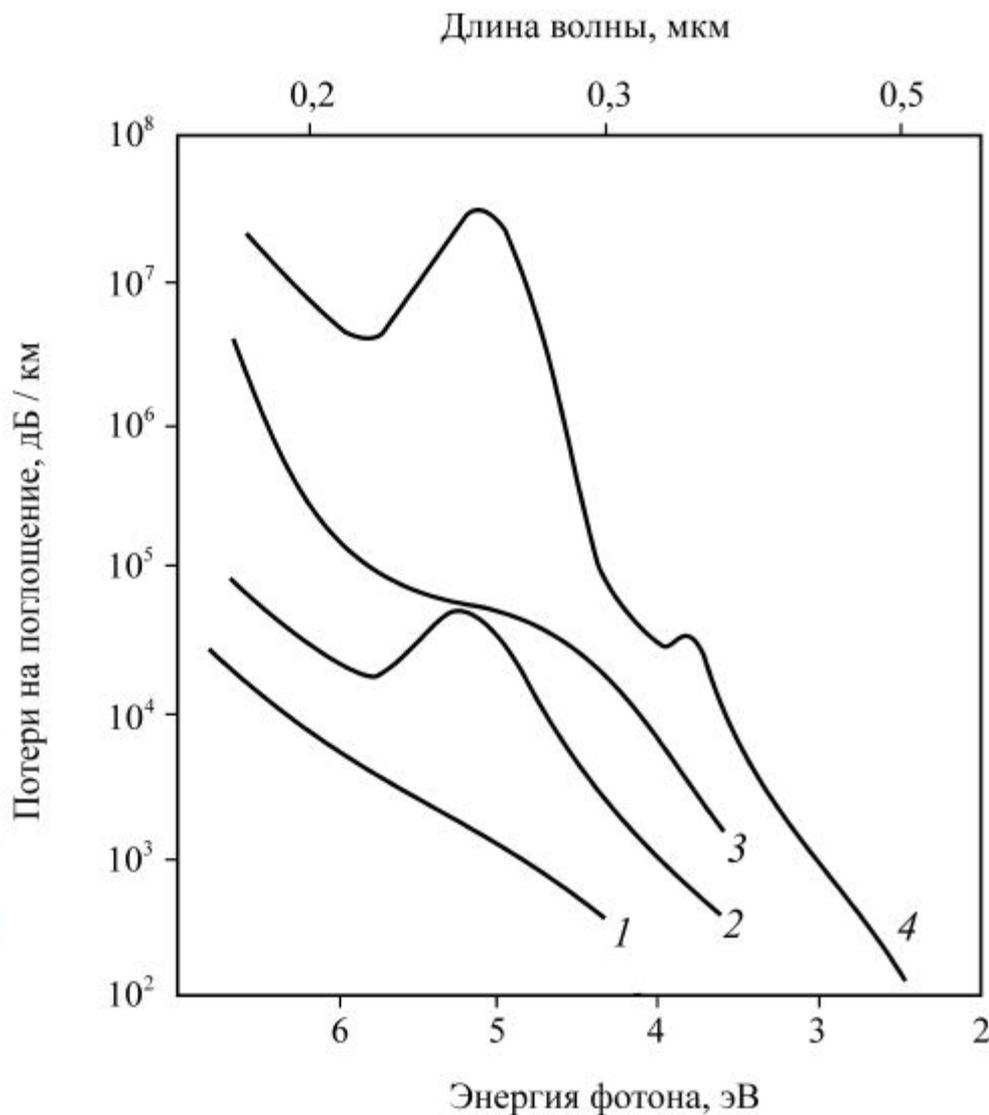
Зависимости потерь на поглощение в УФ-диапазоне от энергии фотонов для чистого (1) и легированного кварцевого стекла: 2 –  $B_2O_3$ ; 3 –  $P_2O_5$ ; 4 –  $GeO_2$
