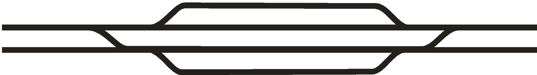
**Обгонный пункт** - отдельный пункт на двухпутных железнодорожных линиях, имеющий путевое развитие, допускающее обгон поездов и в необходимых случаях - перевод поезда с одного главного железнодорожного пути на другой.
