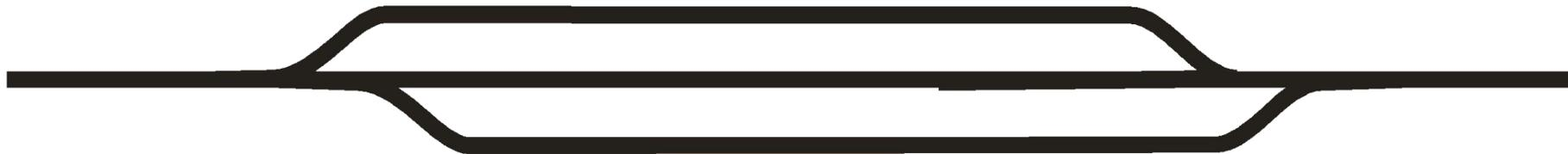
**Разъезд** – отдельный пункт на однопутных железнодорожных линиях, имеющий путевое развитие, предназначенное для скрещения и обгона поездов.
