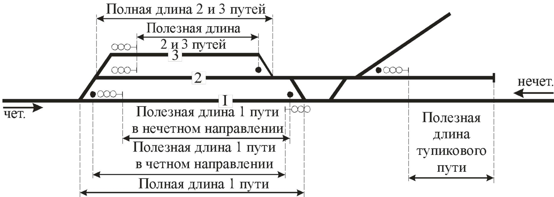
**Полная длина пути** – это расстояние между стыками рамных рельсов стрелочных переводов, ограничивающих этот путь. Для тупикового пути полная длина – это расстояние от стыка рамного рельса стрелочного перевода - до упора.
