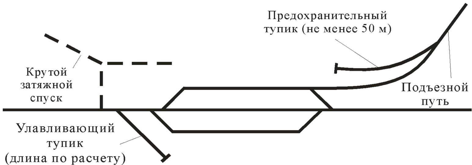
Улавливающий тупик - тупиковый железнодорожный путь, предназначенный для остановки потерявшего управление поезда или части поезда при движении по затяжному спуску.
