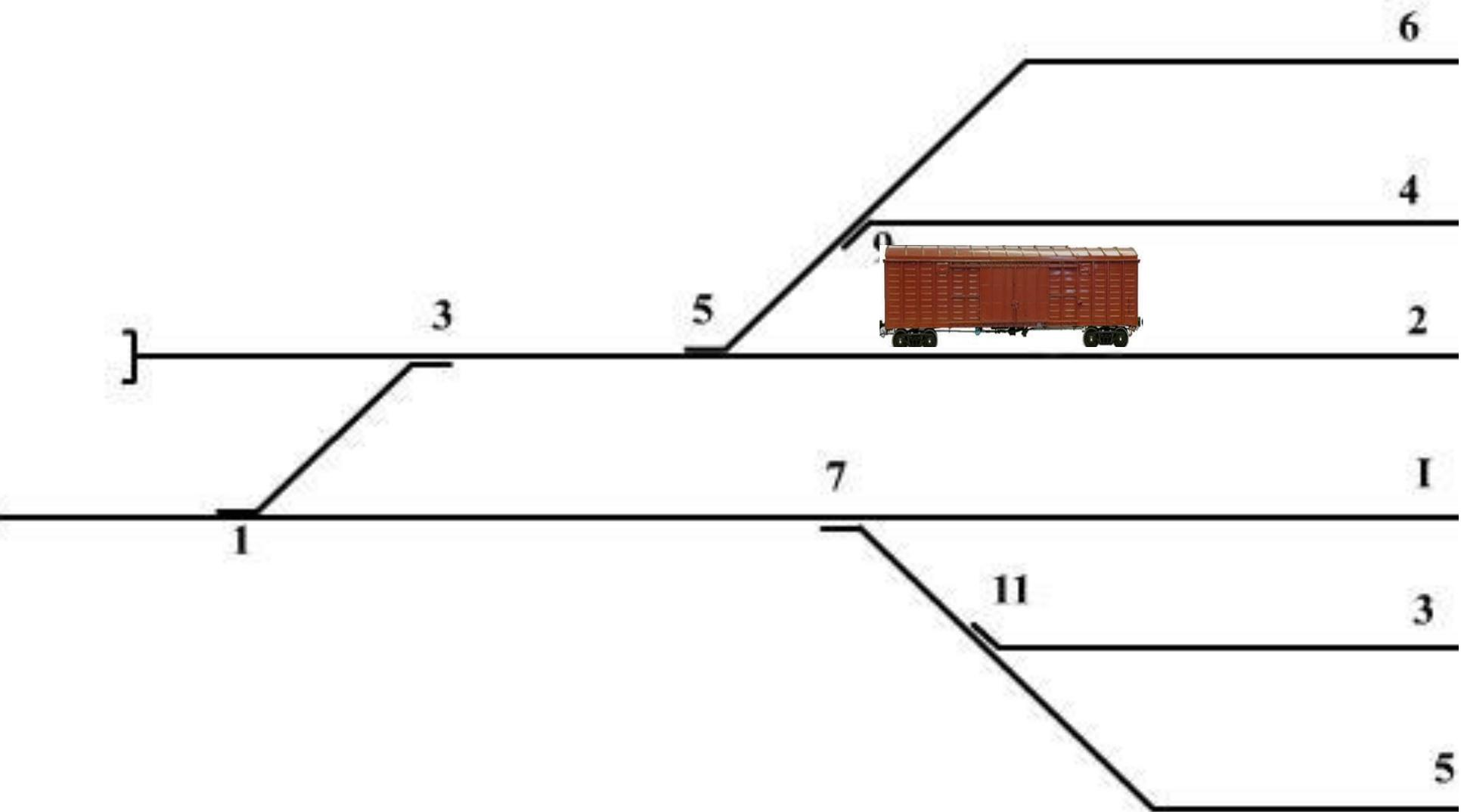
Предохранительный тупик - тупиковый железнодорожный путь, предназначенный для предупреждения выхода железнодорожного подвижного состава на маршруты следования поездов.
