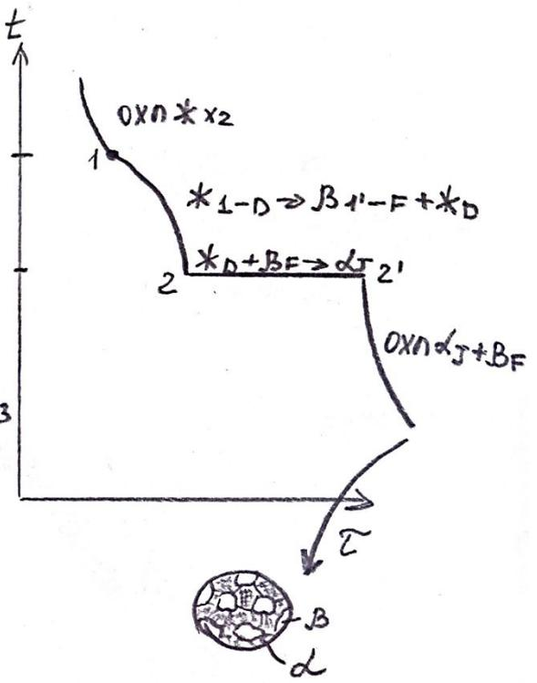
При достижении линии DJF сплав претерпевает безвариантное превращение ( $C = K - \Phi + 1 = 2 - 3 + 1 = 0$ ), оно называется перетектическим:
