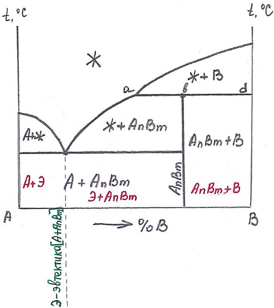
при достижении горизонтали abd инконгруэнтное (состав жидкости не совпадает с составом твердой фазы) плавление:
