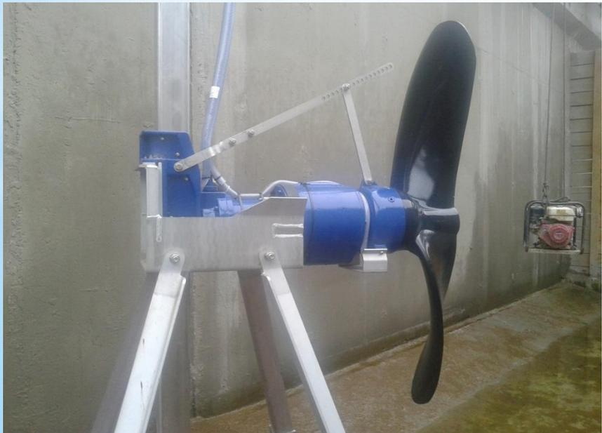
В аноксидной зоне для перемешивания иловой смеси установлены погружные мешалки. Число оборотов в минуту- 1400.
