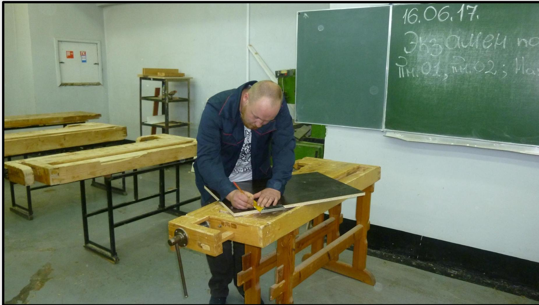
Операция разметки отверстий на заготовке
