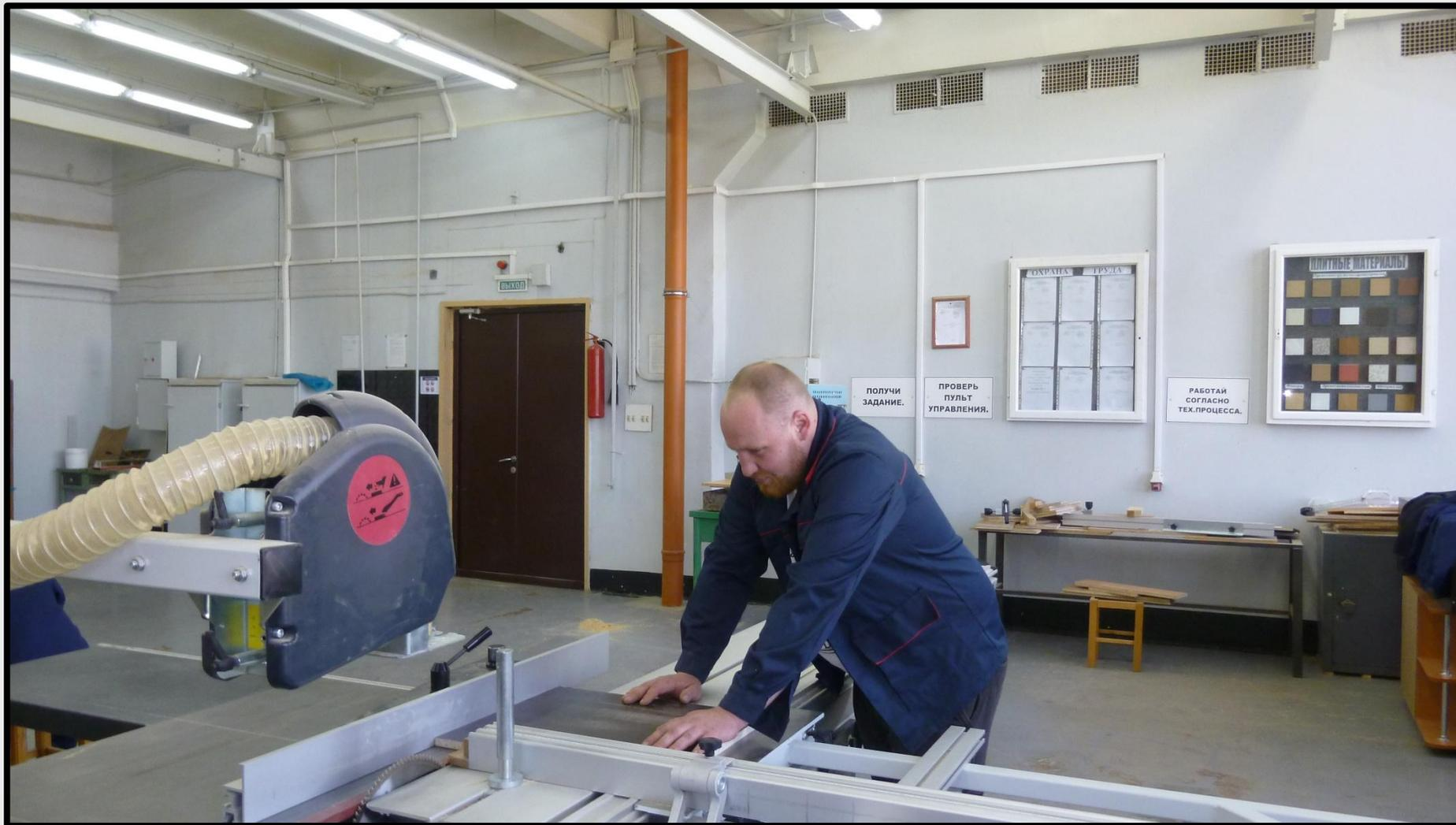
Операция раскроя заготовки на круглопильном станке
