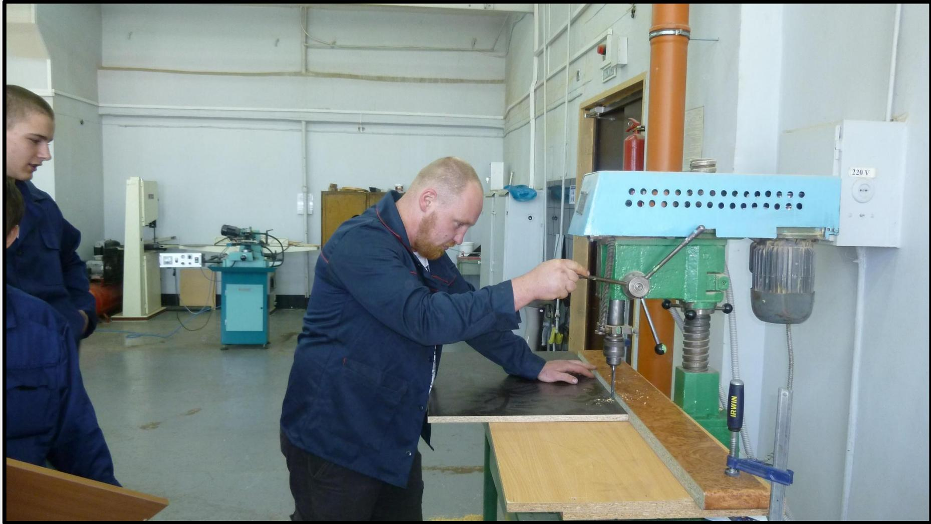
Операция сверления отверстий на сверлильном станке
