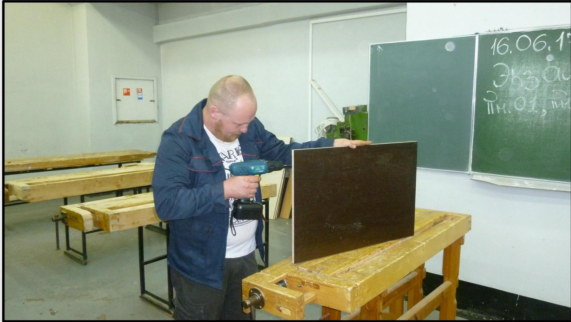
Операция сверления ручным инструментом (шуруповёрт)
