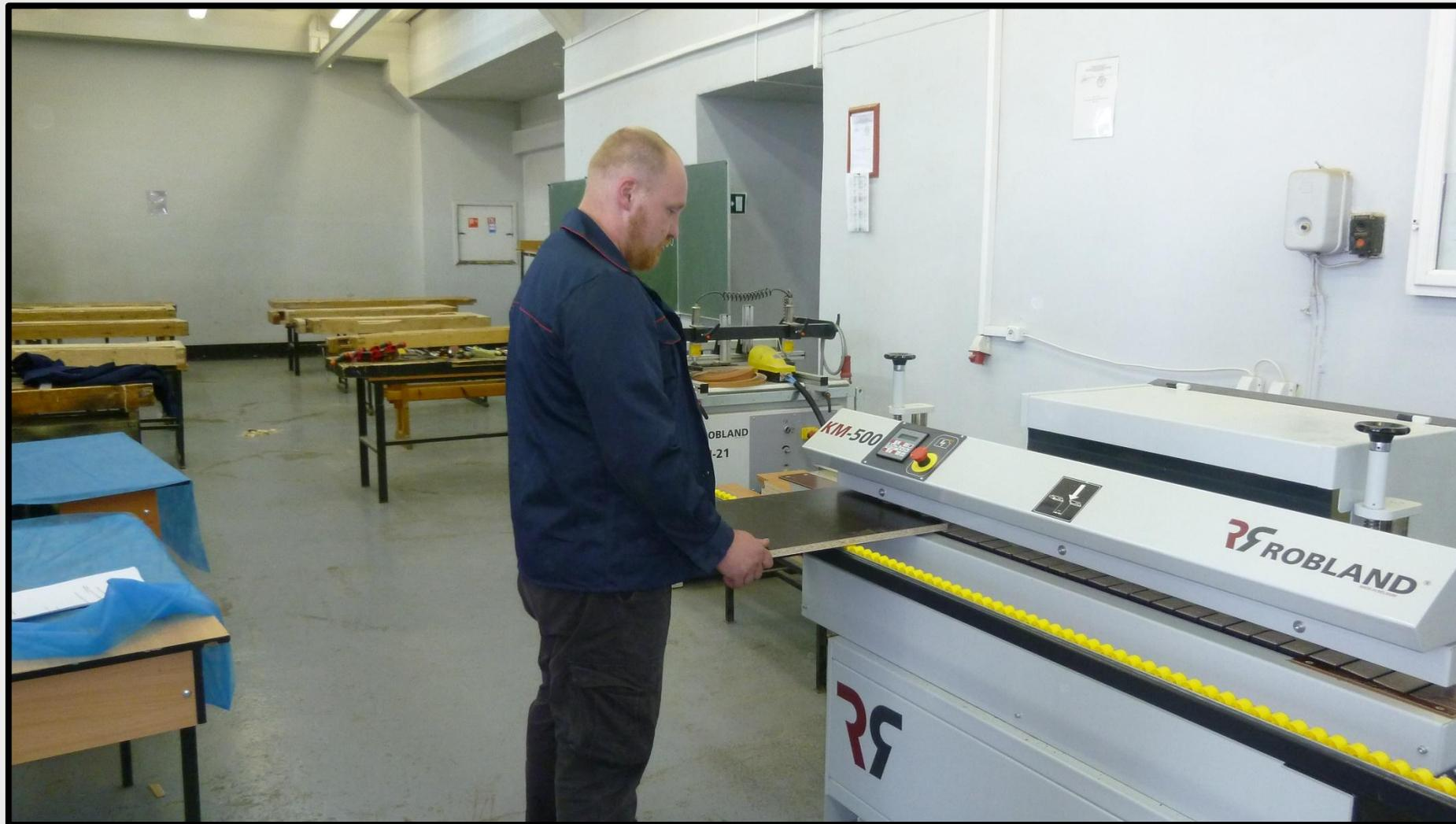
Операция облицовывания заготовки на кромочном станке
