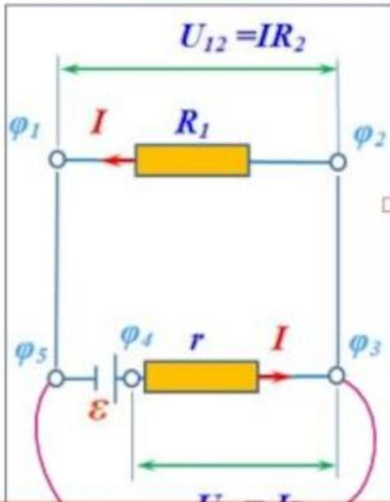
Эта формула выражает **закон Ома для полной (замкнутой) цепи**: сила тока в **полной цепи** равна электродвижущей силе
