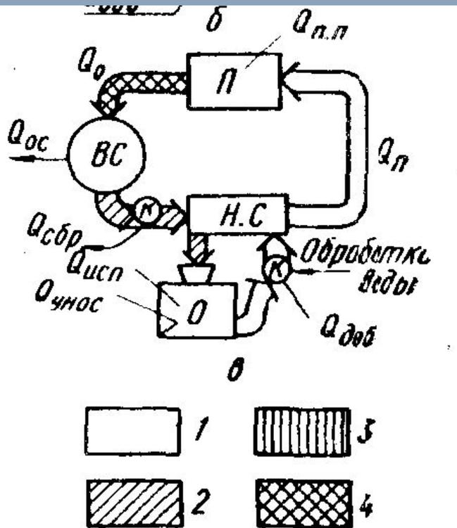
Систему водоснабжения следует устраивать, как правило, оборотом воды, общим для всего промышленного предприятия или в виде замкнутых циклов для отдельных производств, цехов или установок.
