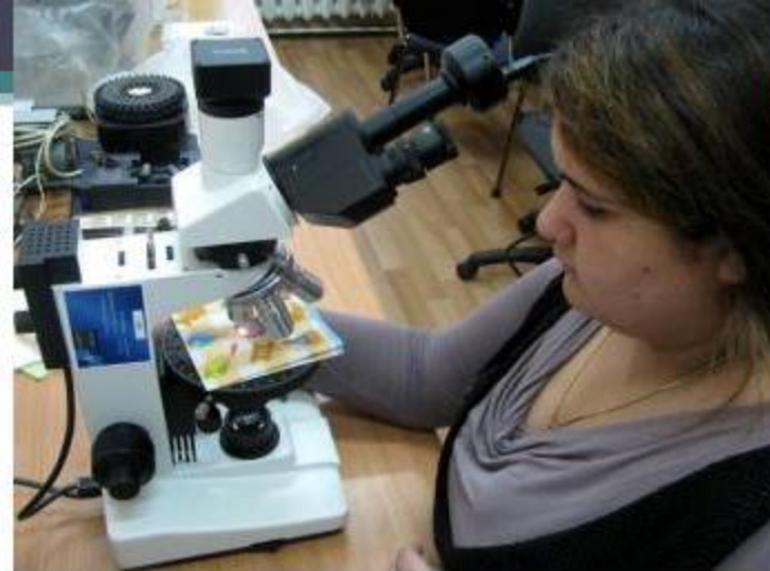
Структура салфеток под микроскопом. Увеличение в 50 раз
