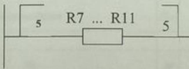
Рис.3 Изображение параллельного соединения с одинаковыми элементами
