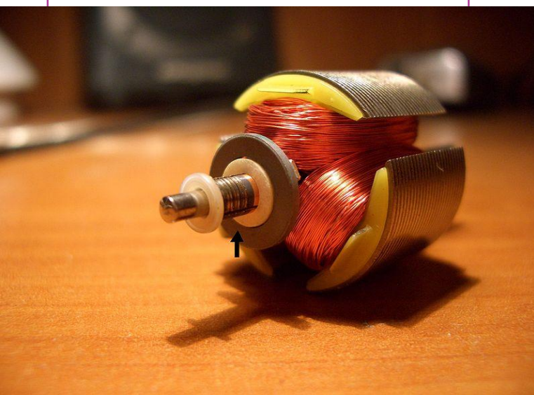
Ротор(якорь) и статор(индуктор)
