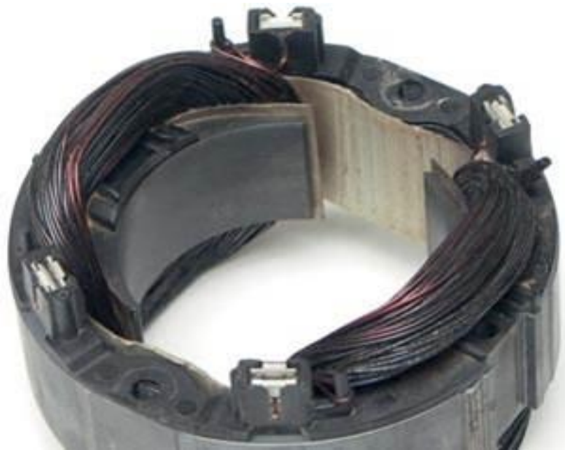
Ротор(якорь) и статор(индуктор)
