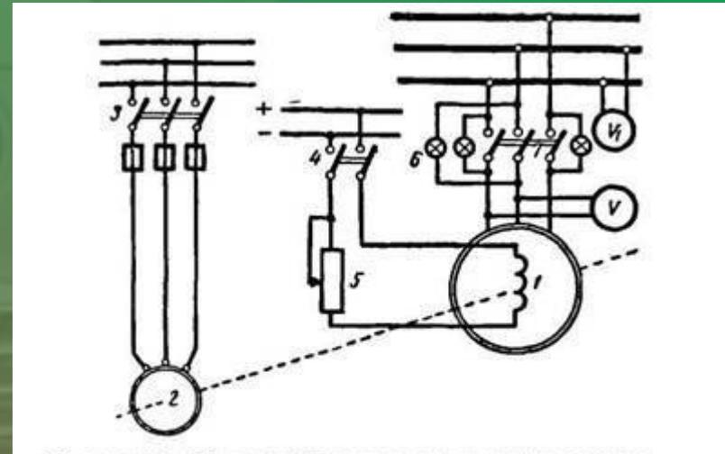
При включении синхронного двигателя в сеть трехфазного тока, требуется синхронизация, осуществляемая реостатом (5). Реостат организует возбуждение, позволяющее установить напряжение обмотки статора, определяемое вольтметром V, равное напряжению в сети, которое указывает вольтметр V1.
