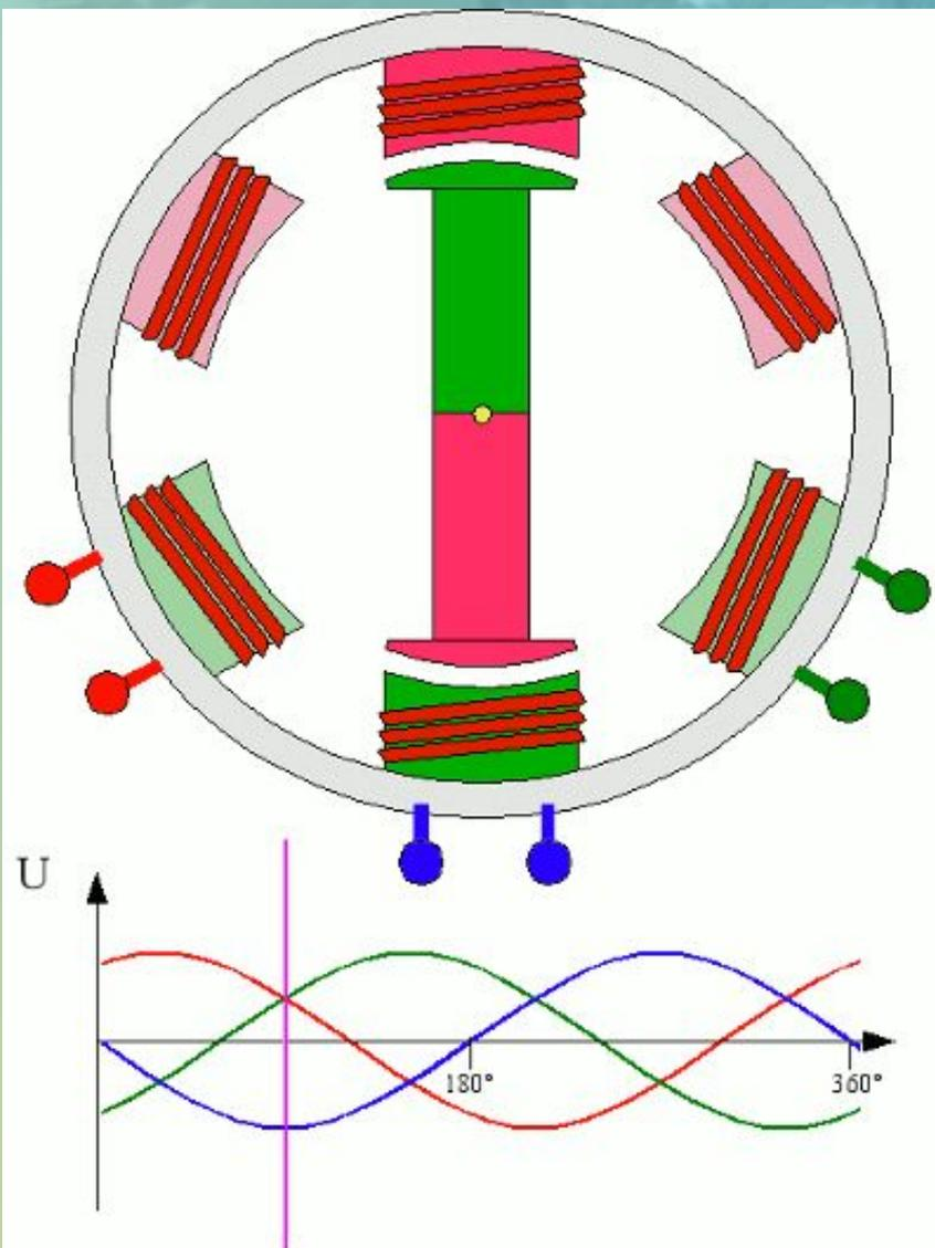
Принцип действия синхронного двигателя основывается на взаимном влиянии магнитных полей якоря и полюсов индуктора. При обращенной конструкции агрегата расположение якоря и индуктора выполнено наоборот, то есть, первый расположен на роторе, а другой – на статоре. Такой вариант используют криогенные синхронные машины, у которых в состав обмоток возбуждения входят материалы со свойствами сверхпроводимости.
