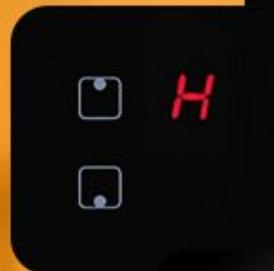
**Индикация остаточного нагрева** защитит от прикосновения к горячей поверхности!
