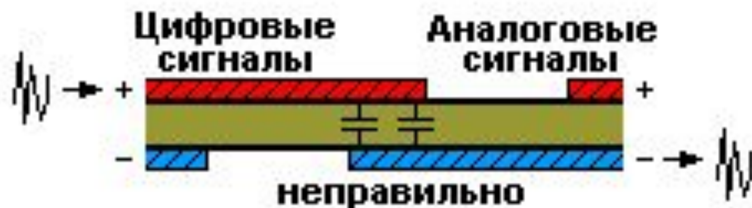
Рис.1. Размещение полигонов аналоговых и цифровых сигналов
