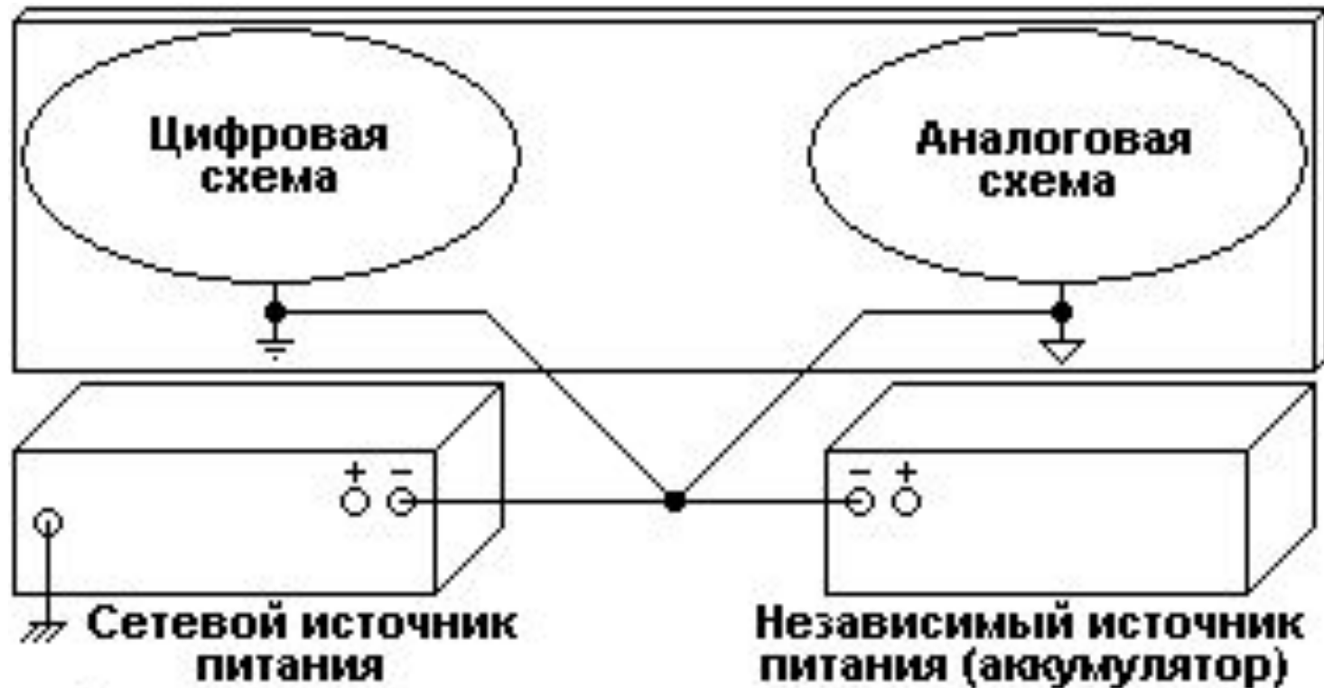
Рис.2. Разделение аналоговой и цифровой земли
