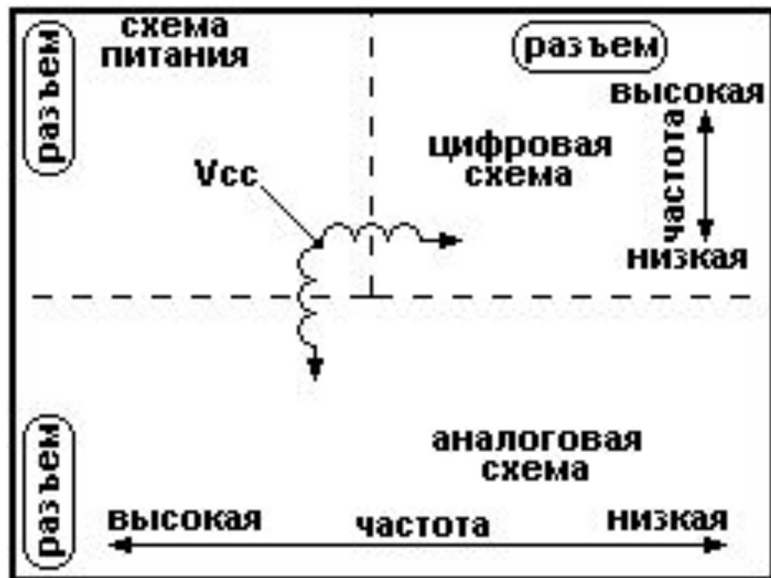
Рис.4. Пример хорошего размещения компонентов на плате
