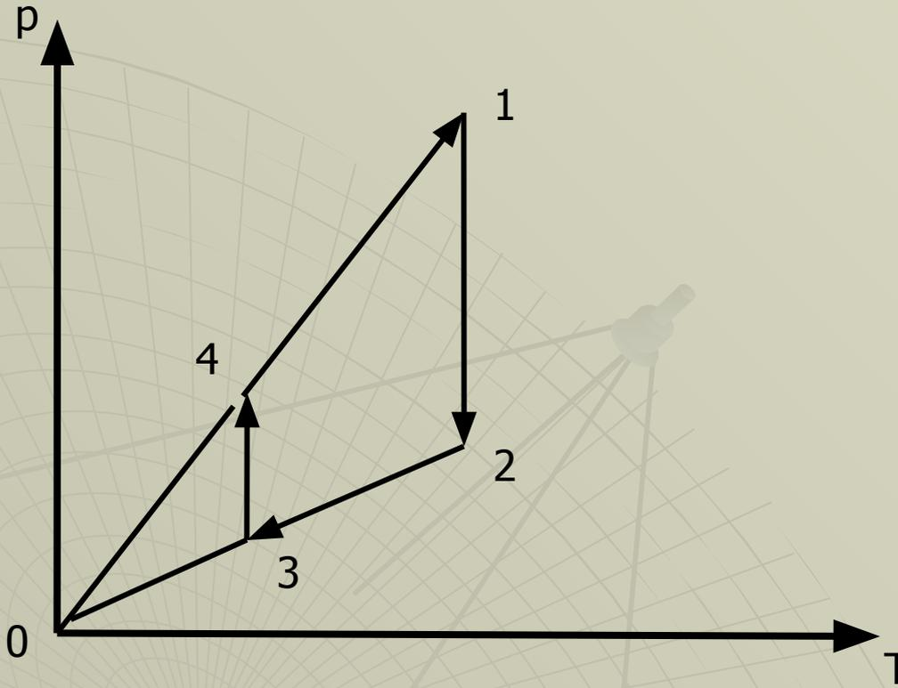
1-2 изотермический , 2-3 изохорический, 3-4 изотермический, 4-1 изохорический. Составим таблицу для основных термодинамических характеристик соответствующих процессов: работы  $A$ , изменения внутренней энергии
