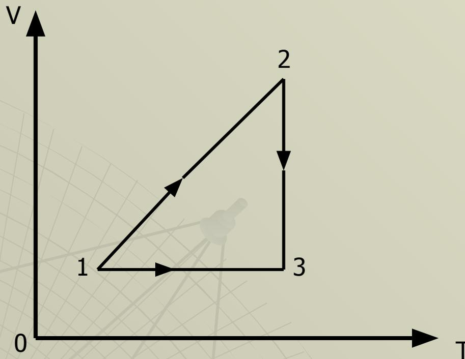
Поскольку на осях координат не указан масштаб, то по графику можно установить только относительное значение объемов и температур газа для различных моментов замкнутого процесса.
