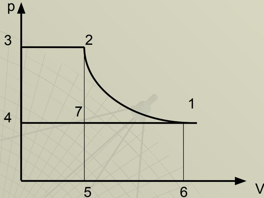
Работа за цикл изображается площадью фигуры 1 – 2 – 3 – 4 – 1. Площадь фигуры 2 – 3 – 4 – 7, соответствующая работе при совершении части цикла, равна
