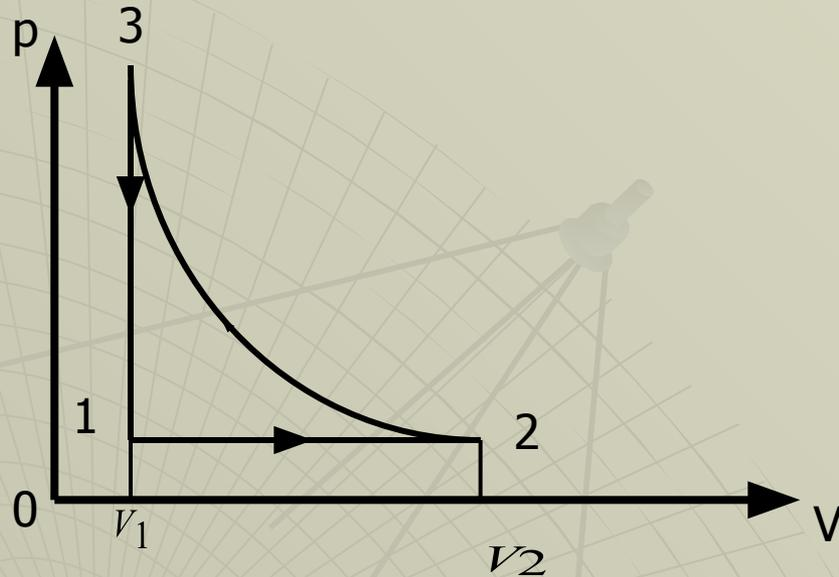
Изобарный переход 1 – 2 в координатных осях  $p, V$  изобразится прямой линией, параллельной оси  $OV$ . Значения
