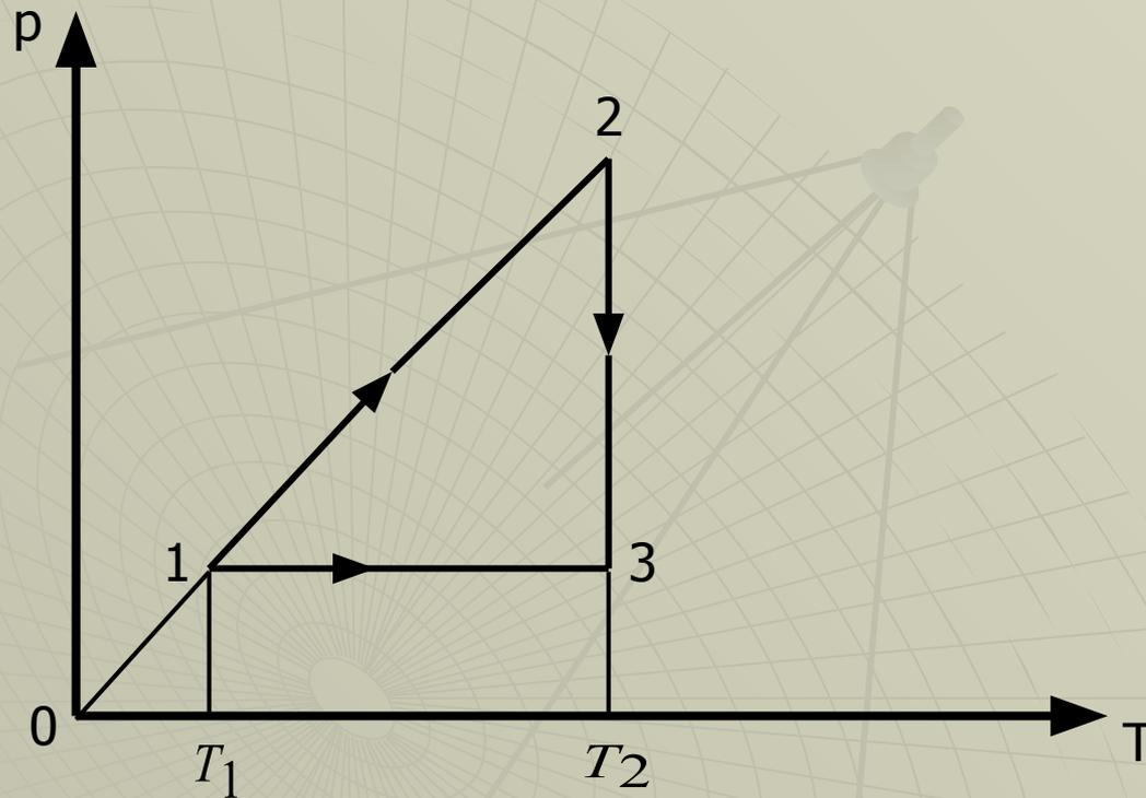
Значение  $p_1$  выберем произвольно. Изобарный процесс 1 – 2 изобразится прямой линией, параллельной оси  $OT$ . Поскольку по условию изотермический процесс сопровождается уменьшением объема, изотерма 2 – 3 изобразится вертикальной линией.
