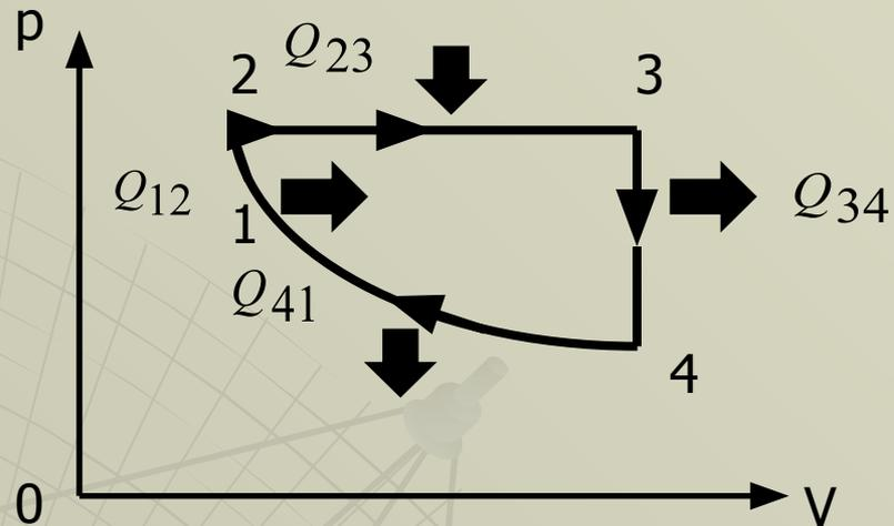
В координатах  $(p, V)$  цикл обходится по часовой стрелке, следовательно, мы имеем дело с тепловым двигателем. Работа газа за цикл  $A_0 = Q_1 - Q_2 > 0$  больше тепла  $Q_1$ , полученного от нагревателя, отданного  $Q_2$  холодильнику.
