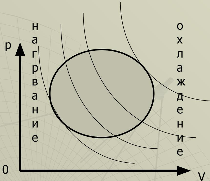
Кривая уравнения изотермы в координатах  $p, V$  – гипербола;  $pV = \text{const}$ , причем чем меньше температура газа, тем больше гипербола прижимается к осям координат. Нарисовав семейство гипербол, находим ответ.
