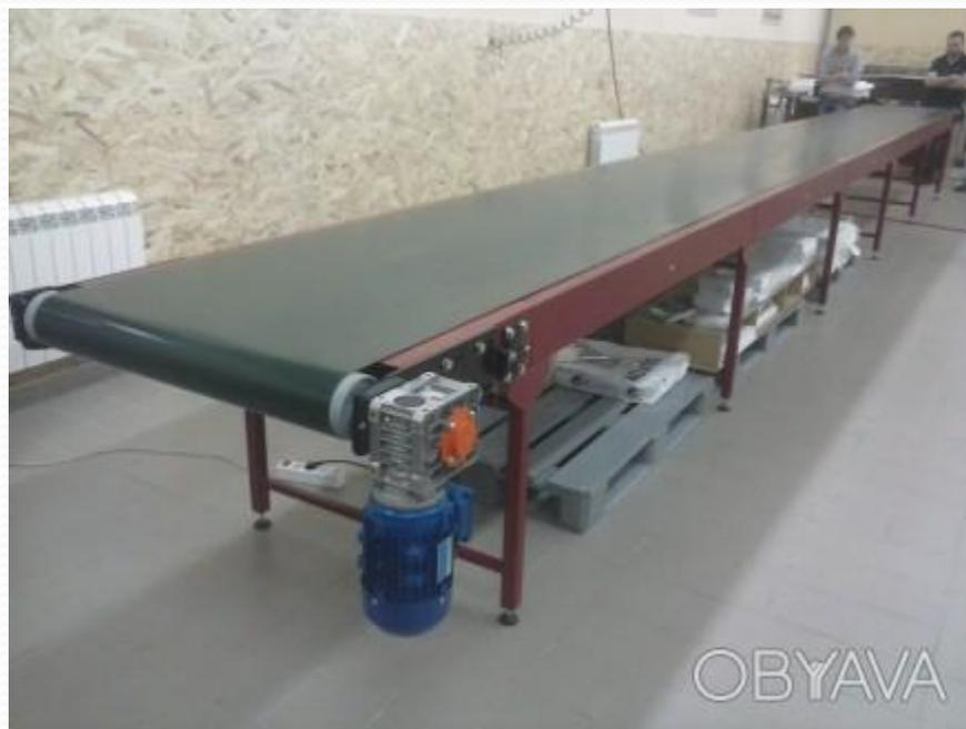
2.2 Ленточный конвейер (рисунок 16) состоит из бесконечной резиновой ленты 1, огибающей приводной 2 и натяжной 3 барабаны. Лента поддерживается опорными роликами 4 и 5. Приводной барабан получает вращение от электродвигателя 6 через редуктор 7 или иную передачу
