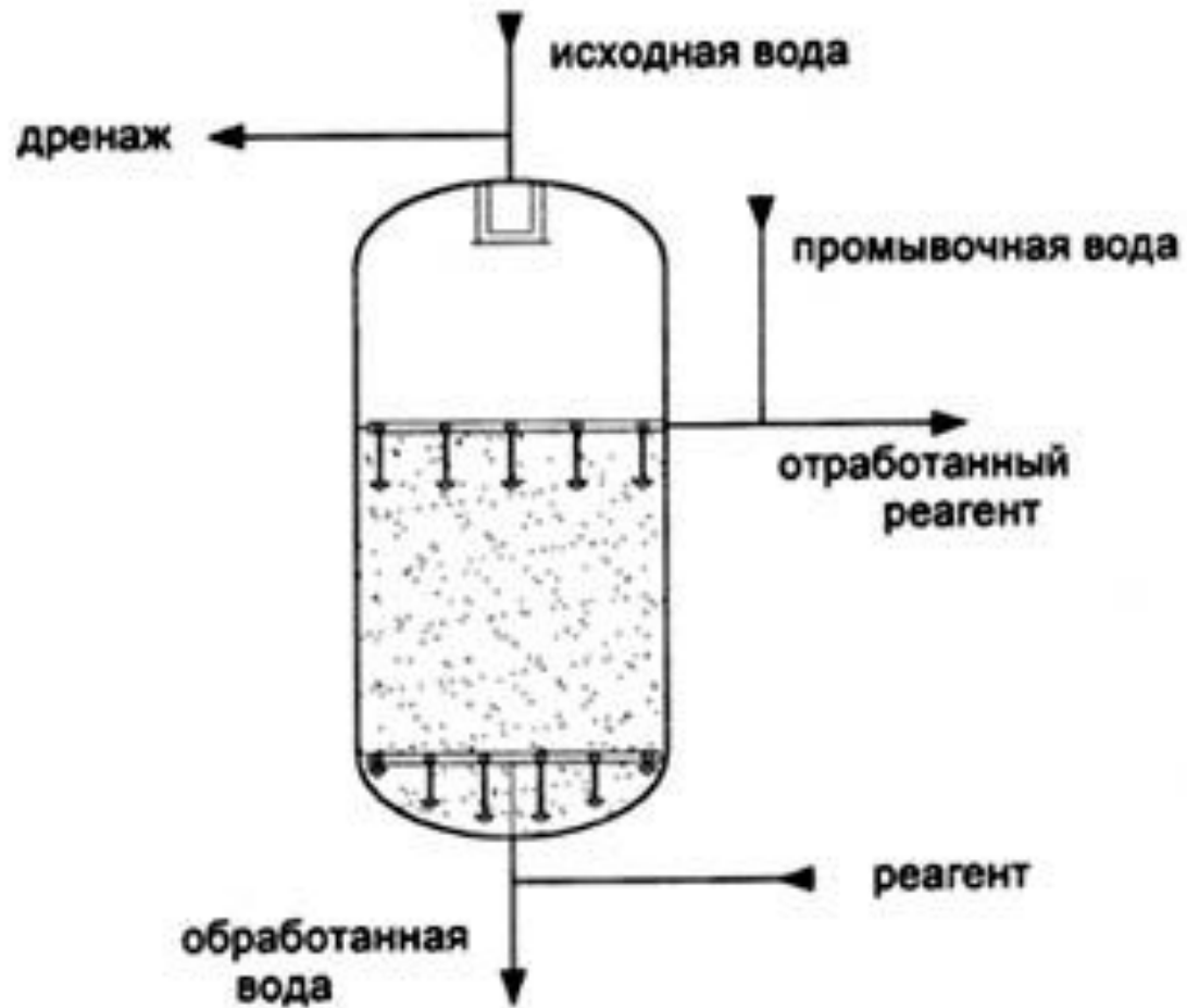
Схема противоточного ионирования
