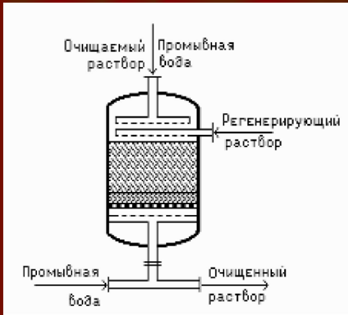
Ионообменный аппарат с неподвижным слоем ионита
