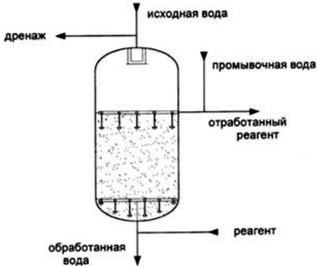
Схема противоточного ионирования
