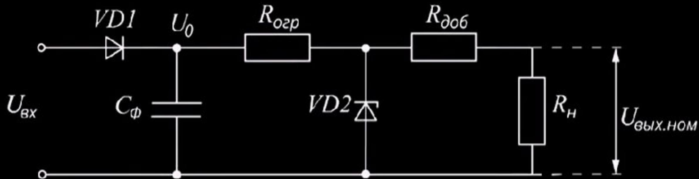
4. Выбираем ток стабилизации стабилитрона ( $I_{ст}$ ) в диапазоне  $(3 - 5)I_{н}$ , чтобы нагрузка как можно меньше влияла на режим работы схемы.
