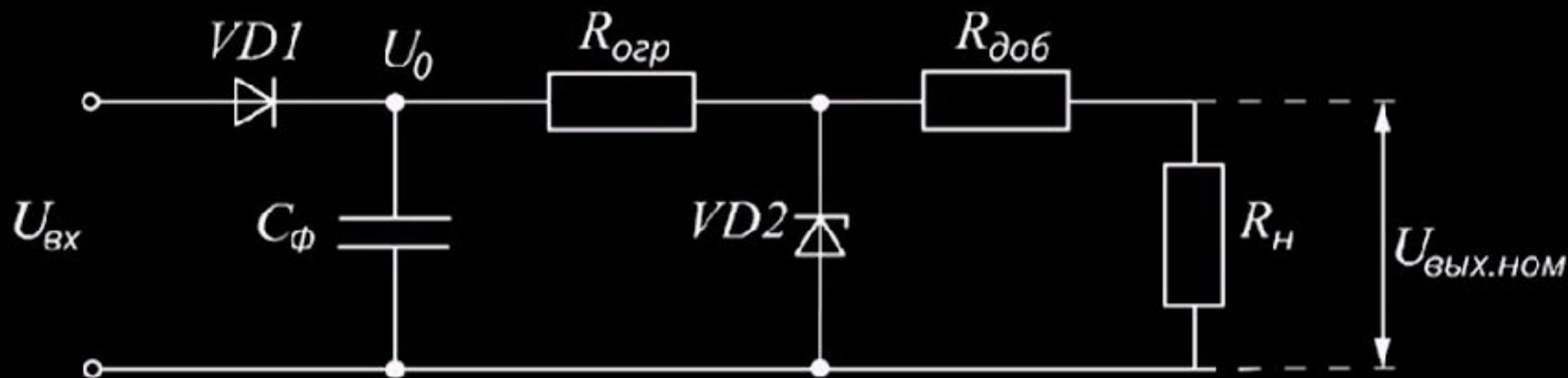
2. Для гашения лишнего падения напряжения в схему вводится добавочный резистор  $R_{доб}$ , образующий с  $R_{н}$  делитель напряжения.  $R_{доб}$  выбирается ближайшим числом из ряда E24.
