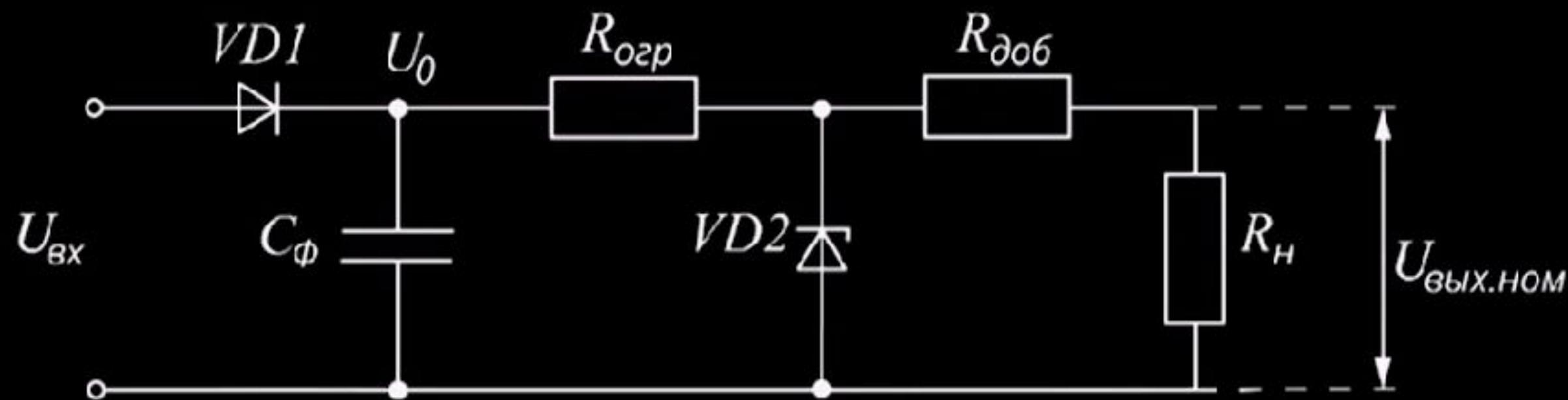
2. Для гашения лишнего падения напряжения в схему вводится добавочный резистор  $R_{доб}$ , образующий с  $R_H$  делитель напряжения.  $R_{доб}$  выбирается ближайшим числом из ряда E24.
