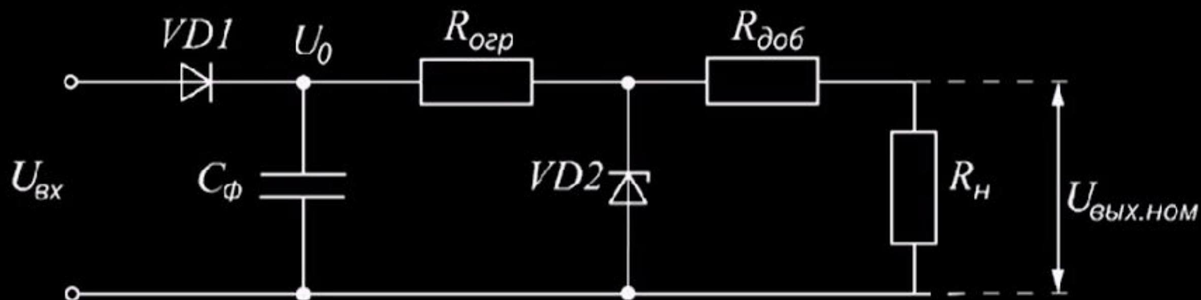
4. Выбираем ток стабилизации стабилитрона ( $I_{ст}$ ) в диапазоне  $(3 - 5)I_{н}$ , чтобы нагрузка как можно меньше влияла на режим работы схемы.
