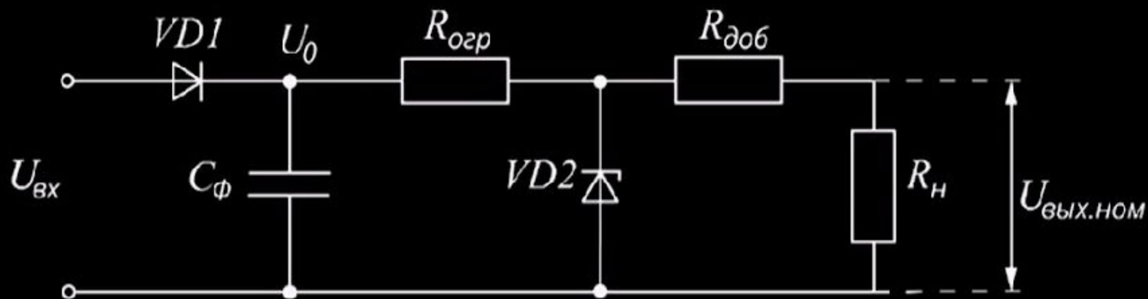
1. Выбирается основной параметр стабилизатора - напряжение стабилизации ( $U_{ст}$ ). Этот параметр должен быть ближайшим большим к  $U_{вых.ном}$  числом из параметрического ряда E24 (нужно воспользоваться справочником).
