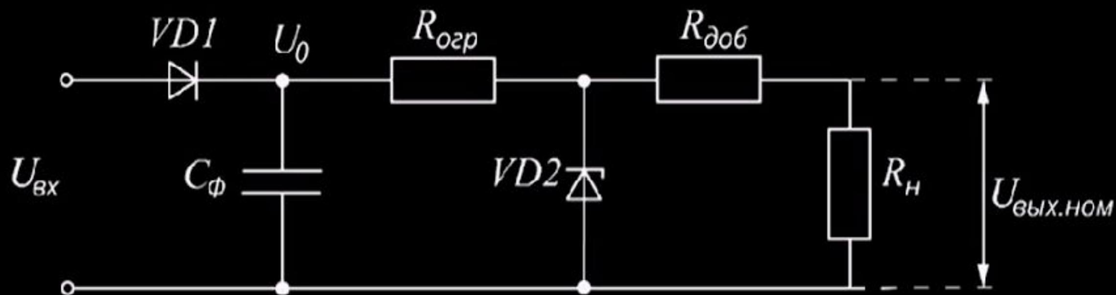
8. Рассчитывается емкость фильтра  $C_\phi$ , обеспечивающая заданный коэффициент пульсаций.
