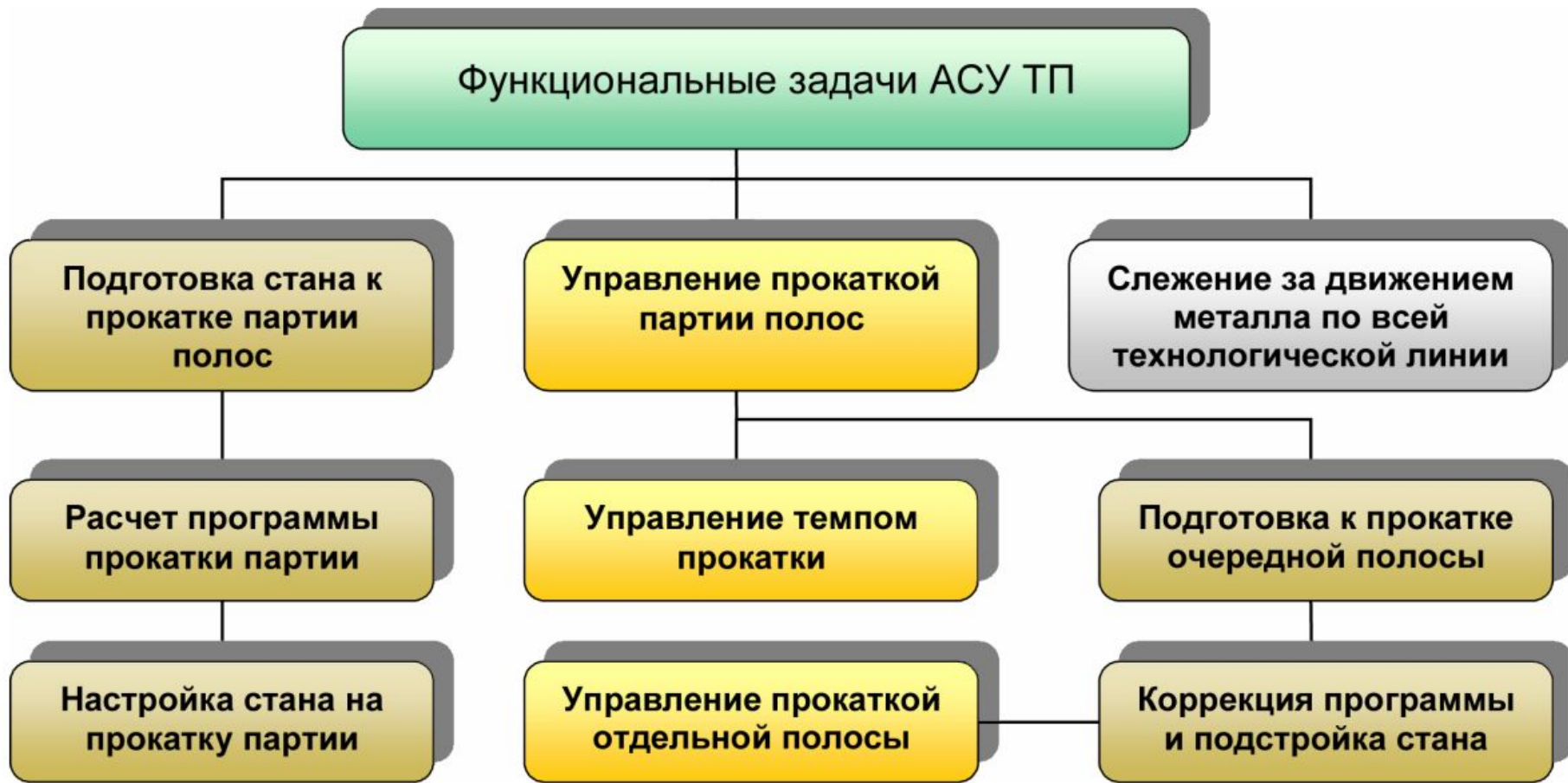
Рис. 1.1. Функциональные задачи АСУ ТП прокатного стана
