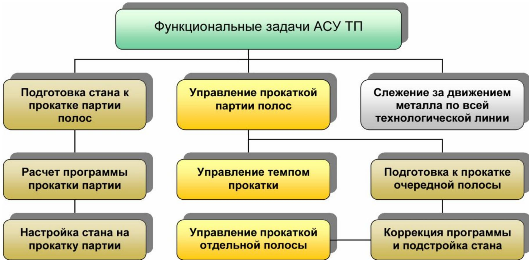
**Рис. 1.1.** Функциональные задачи АСУ ТП прокатного стана
