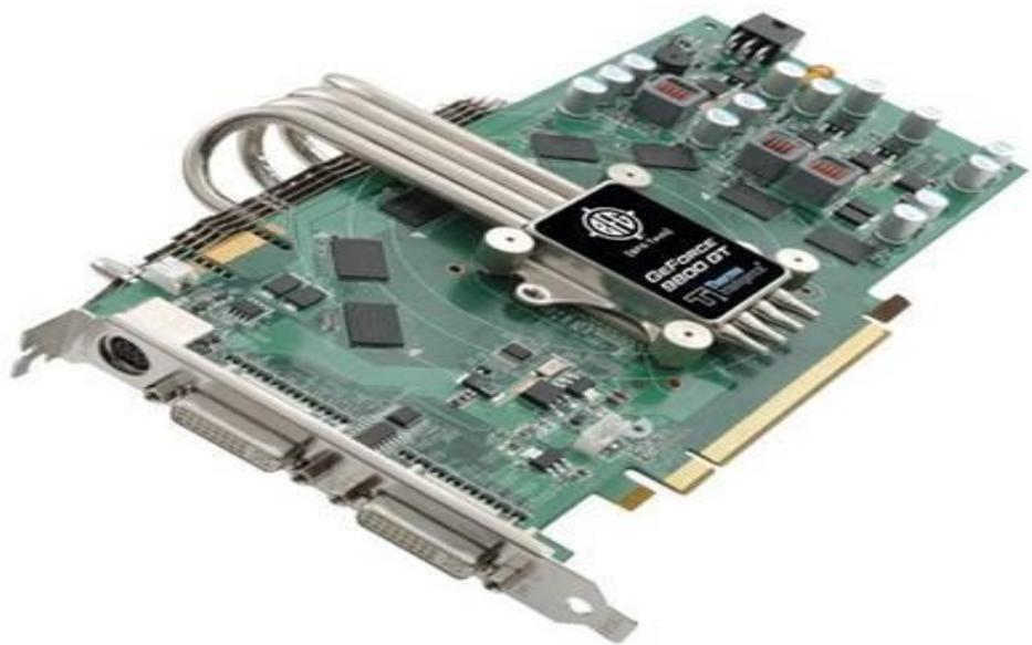
**Видеокарта.** (Видеоплата, видеоадаптер, videoadapter, videocard)- отвечает за обработку и вывод графической информации на монитор.
