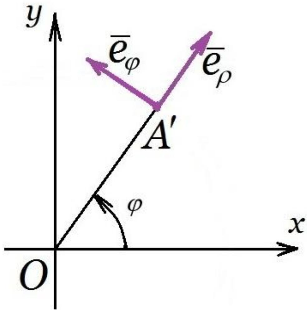
Заметим, что построенные выше векторы  $\bar{e}_\rho$ ,  $\bar{e}_\varphi$ ,  $\bar{e}_z$  образуют правый ортонормированный базис (в пространстве геометрических (свободных) векторов  $V^3$ ). В силу зависимости векторов  $\bar{e}_\rho$  и  $\bar{e}_\varphi$  от угла  $\varphi$ , этот базис является подвижным.
