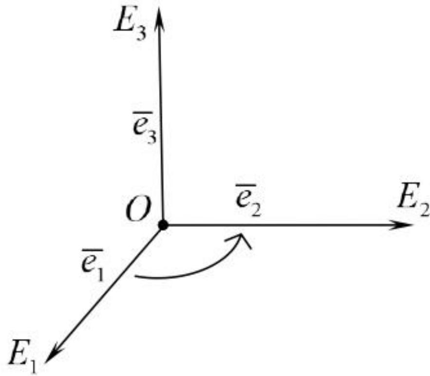
Для векторов  $\overline{OE}_1$ ,  $\overline{OE}_2$ ,  $\overline{OE}_3$  мы будем использовать обозначения  $\bar{e}_1, \bar{e}_2, \bar{e}_3$  (иногда  $\bar{e}_x, \bar{e}_y, \bar{e}_z$  или  $\bar{i}, \bar{j}, \bar{k}$ ).
