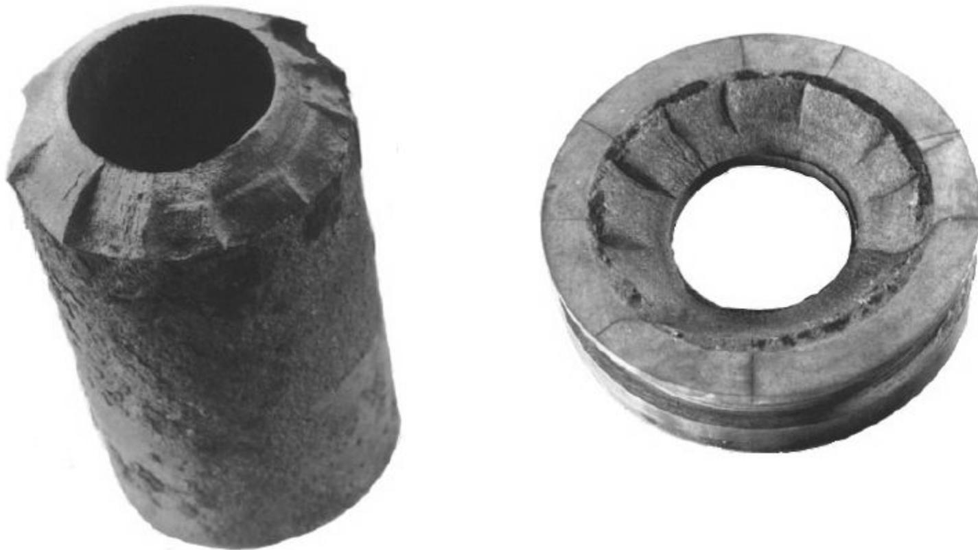
Трещина зародилась в ОШЗ соединения цилиндра с фланцем, и при давлении внутри цилиндра 200 Атм. произошло разрушение
