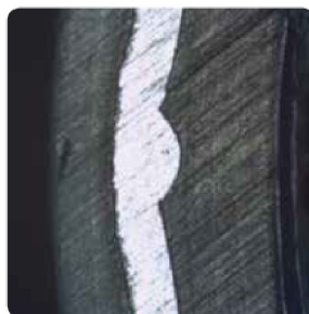
Алюминий, сваренный встык (существующая технология)
