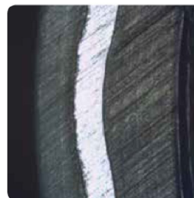
Бесшовный алюминий (новейшая технология SACP = Seamless Aluminium Composite Pipe)
