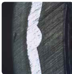
Алюминий, сваренный встык (существующая технология)
