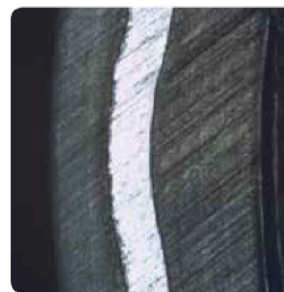
Бесшовный алюминий (новейшая технология SACP = Seamless Aluminium Composite Pipe)
