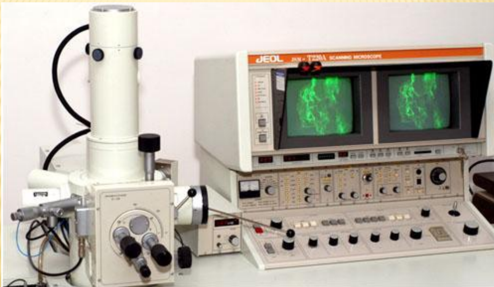
Рис. 4 Скануючий електронний мікроскоп JEOL JSM-T220A
