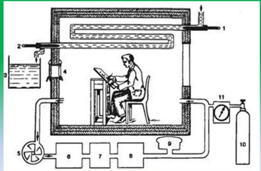
1,2- термометры, 3- бак с водой; 4-окно для подачи пищи и удаления экскрементов; 5-насос для извлечения воздуха из камеры; 6,8-банки с серной кислотой, (для поглощения воды) ; банки с натронной известью для поглощения CO<sub>2</sub>; 10- баллон с кислородом.
