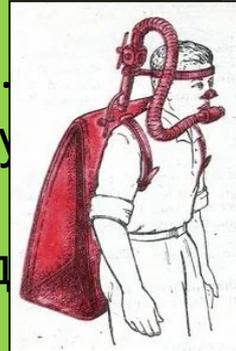
Мешок крепится на спине. В мешок собирается воздух выдыхаемый при работе. По окончании работы воздух анализируют с помощью газоанализаторов. Зная состав атмосферного воздуха, рассчитывают количество потребленного кислорода и выделившегося углекислого газа.
