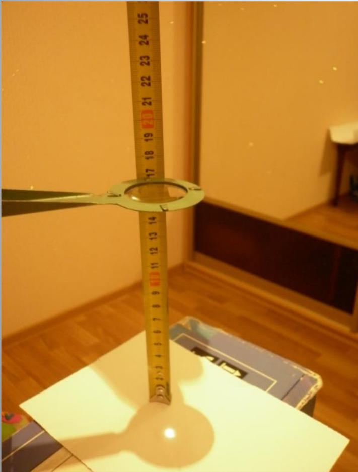
Размеры и расположение изображения предмета в собирающей линзе зависят от расположения предмета относительно линзы.
