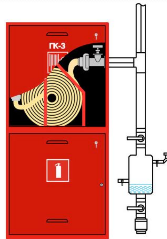
Типовая схема воздухозаполненной системы внутреннего противопожарного водопровода
