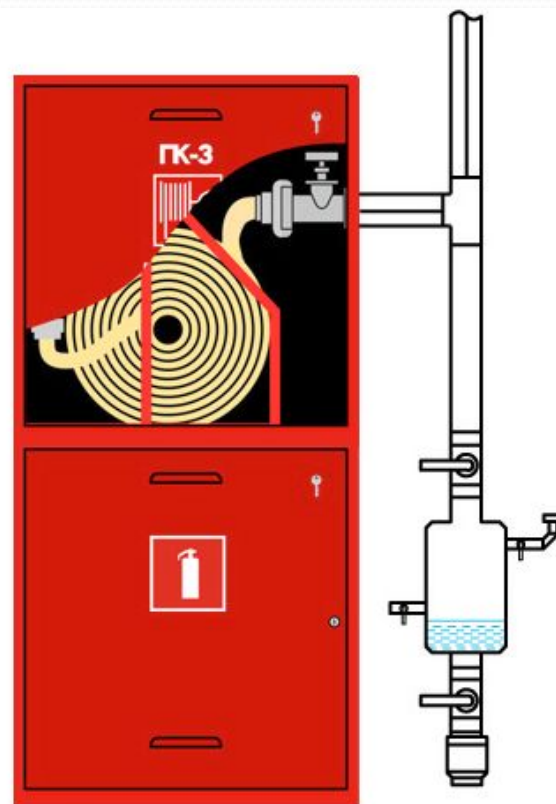
Типовая схема воздухозаполненной системы внутреннего противопожарного водопровода
