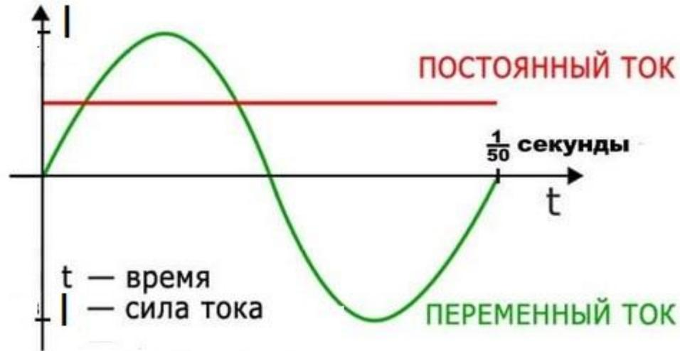
Рис. Постоянный и переменный ток
