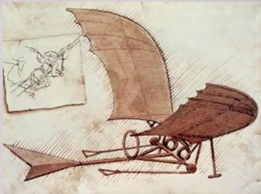
Увлекаясь идеей создания летательного аппарата, Леонардо разработал сначала простейший аппарат на основе крыльев. Новой его идеей стал аэроплан с полным управлением. Однако ее воплотить в жизнь не удалось из-за отсутствия мотора. Также знаменитой идеей ученого является аппарат с вертикальным взлетом и посадкой.
