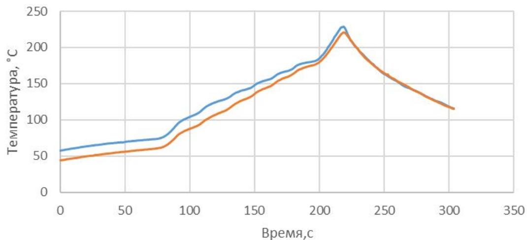
Термопрофиль при пайке 0 торр.
