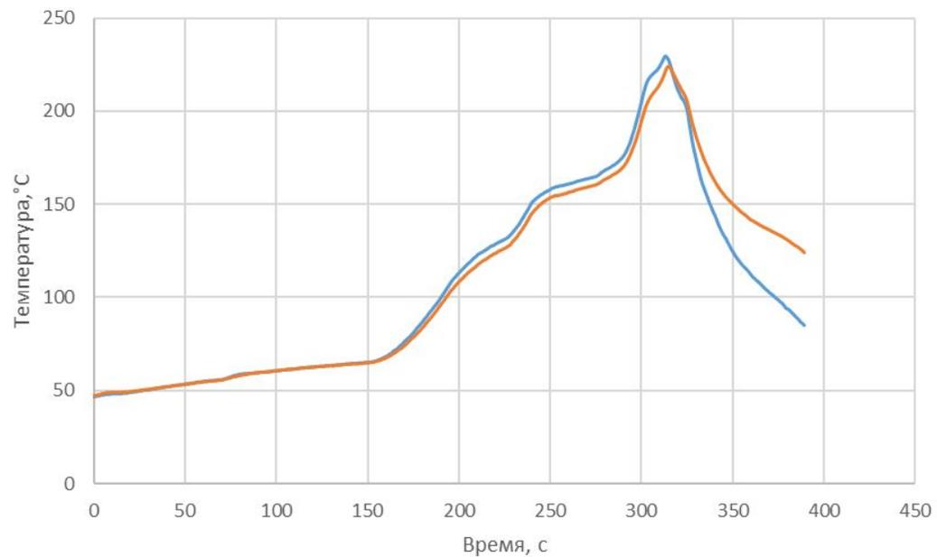
Термопрофиль при поперечном охлаждении.
