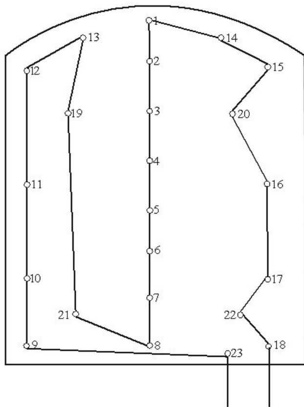
**Сила электрического тока, проходящего через взрывную сеть и через каждый ЭД при последовательном соединении, будет одинаковой и равно 1А, поэтому условия безотказного взрывания выполняются.**
