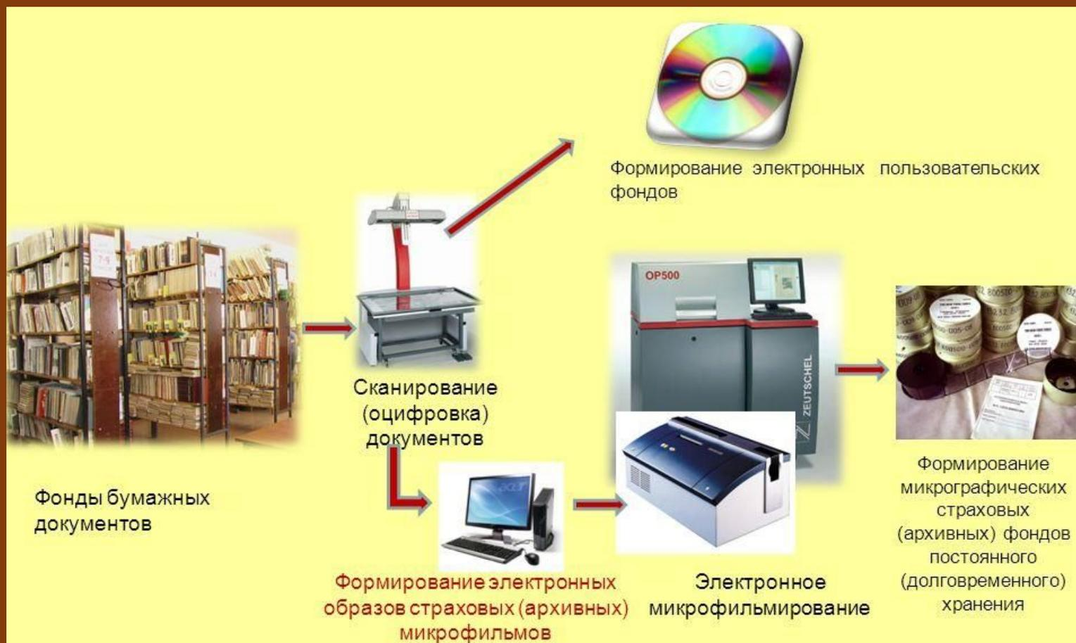
**Интегрированная схема создания микрографических страховых архивных и библиотечных страховых фондов**
