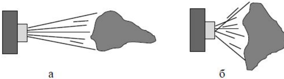
Рис. 2.6. Схема факела распыливания топлива:
